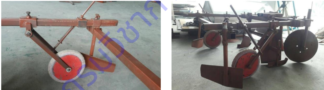
ภาพที่ 5 ชุดขาล้อและใบกลบ ที่ได้รับการปรับปรุงและพัฒนาขึ้นจากต้นแบบเดิม
