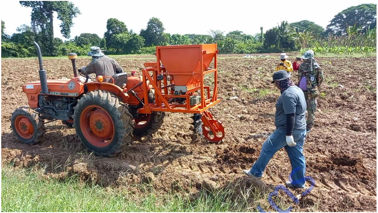
ภาพที่ 8 การทดสอบเครื่องชุดหลุมและใส่ปุ๋ย
