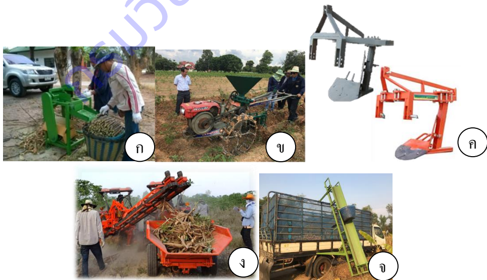
ภาพที่ 1 เครื่องต้นแบบงานวิจัยที่เลือกมาดำเนินการ ได้แก่ เครื่องตัดท่อนพันธุ์มันสำปะหลัง (ก) เครื่องกำจัดวัชพืชและใส่ปุ๋ยแบบต่อพ่วงกับรถไถเดินตาม (ข) เครื่องขุดมันสำปะหลังแบบไถหัวหมู (ค) เครื่องเก็บเกี่ยวมันสำปะหลังแบบกึ่งอัตโนมัติ (ง) และเครื่องลำเลียงหัวมันสำปะหลังขึ้นรถบรรทุก (จ)
