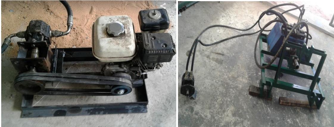
ภาพที่ 6 ชุดกำลังขับเคลื่อนไฮดรอลิกและอุปกรณ์ควบคุม สำหรับการเทียบรอบการทำงาน
