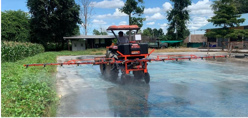
รูปที่ 1 การทดสอบเพื่อเปรียบเทียบอัตราการฉีดพ่น
