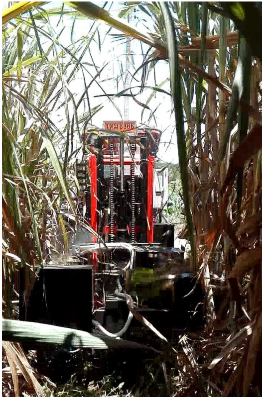
ภาพที่ 1. ลักษณะการทำงานของเครื่องสางใบอ้อย
