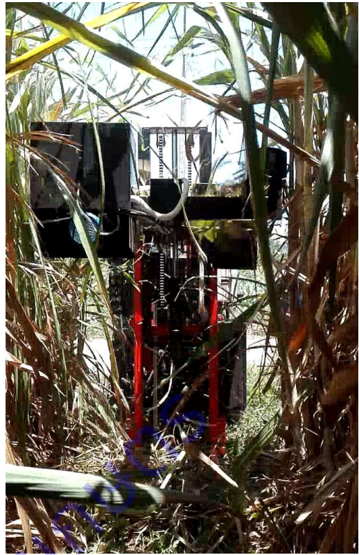
ภาพที่ 1. ลักษณะการทำงานของเครื่องสางใบอ้อย
