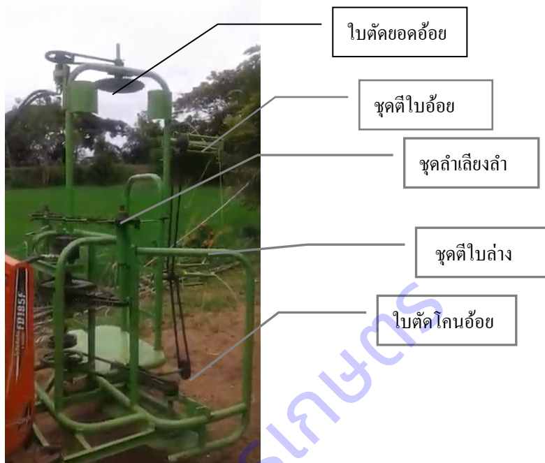
ภาพที่ 8 ต้นแบบเครื่องตัดอ้อยประกอบหน้าแทรกเตอร์ต้นแบบ
