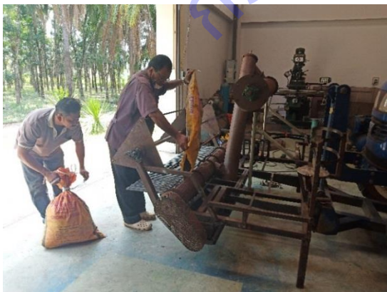
ภาพที่ 22 ทดสอบความสัมพันธ์ของการทำงานของกลไกเครื่องเกี่ยวนวดกระซับหลังติดตั้งมอเตอร์ไฮดรอลิก
