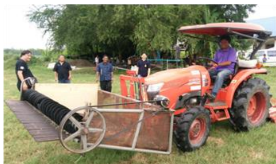
ภาพที่ 4 อุปกรณ์เก็บเมล็ดกระซับติดด้านหน้ารถแทรกเตอร์
