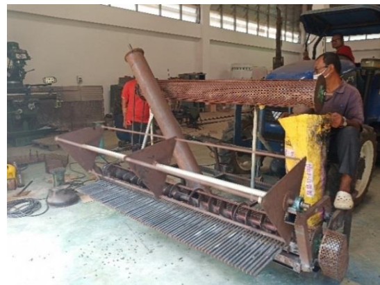
ภาพที่ 22 ทดสอบความสัมพันธ์ของการทำงานของกลไกเครื่องเกี่ยวนวดกระซับหลังติดตั้งมอเตอร์ไฮดรอลิก
