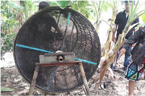
ภาพที่ 7 วงล้อตะแกรงทำความสะอาดเมล็ดกระชับ
