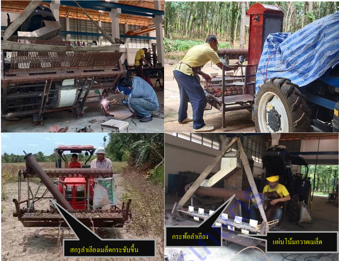
ภาพที่ 27 ปรับปรุงเครื่องเกี่ยวนวดกระบี่หลังลงแปลงทดสอบเก็บข้อมูลแล้ว
