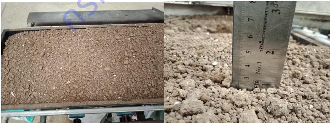
ภาพที่ 25 ชุดโรยดินลงถาดความหนาใกล้เคียง 25 มิลลิเมตร
