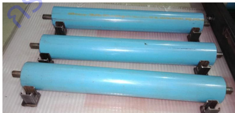
ภาพที่ 20 ลูกกลิ้งรับสายพานลำเลียงถาดเพาะต้นอ่อน
