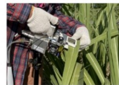
การวัดอัตราการสังเคราะห์แสงของอ้อยในรอบวันโดยใช้เครื่องมือวัดอัตราการสังเคราะห์แสง
