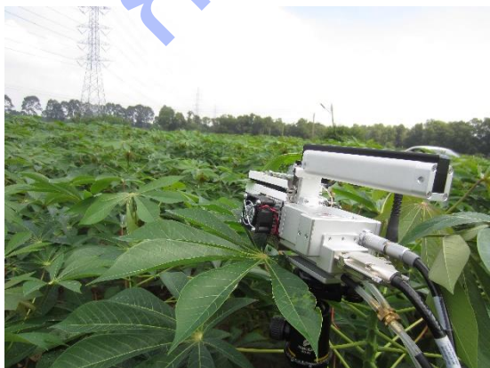
ภาพที่ 1.1.1 เครื่องวัดอัตราการสังเคราะห์แสง รุ่น LI-6400XT Portable Photosynthesis System ที่ใช้วัดอัตราการสังเคราะห์แสงของมันสำปะหลัง
