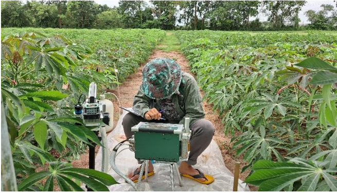
(ภาพที่ 1) การวัดอัตราการสังเคราะห์แสงสุทธิ ที่อายุ 2 เดือนหลังปลูก ในเดือนสิงหาคม
