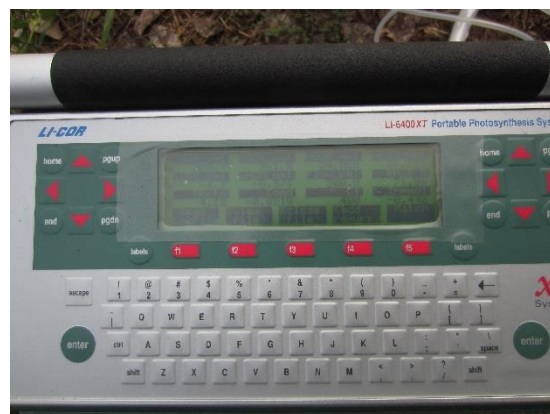
ภาพที่ 1.1.1 เครื่องวัดอัตราการสังเคราะห์แสง รุ่น LI-6400XT Portable Photosynthesis System ที่ใช้วัดอัตราการสังเคราะห์แสงของมันสำปะหลัง
