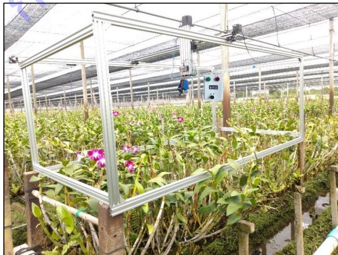
ภาพที่ 2 ระบบตรวจสอบเพลิงไฟ และบัวกล้วยไม้ที่ติดตั้งในโรงเรือน
