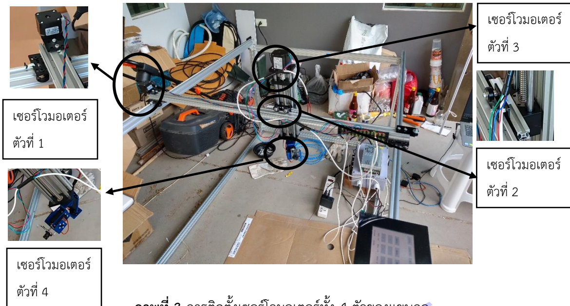
ภาพที่ 3 การติดตั้งเซอร์โวมอเตอร์ทั้ง 4 ตัวของแขนกล
