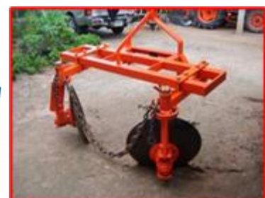
รูปที่ 3 การไถยกร่อง ผานยกร่อง (ก) และผานยกร่องมีโซ่ลากปาดสันร่อง (ข)
