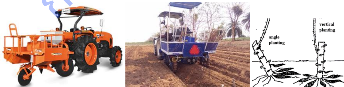
รูปที่ 6 เครื่องปลูกมันสำปะหลังแบบปักท่อนพันธุ์ในแนวตั้ง
