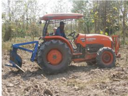
รูปที่ 17 ฝานขุดมันสำปะหลังต้นแบบงานวิจัย (ก) และฝานขุดมันสำปะหลังของเกษตรกร (ข)
