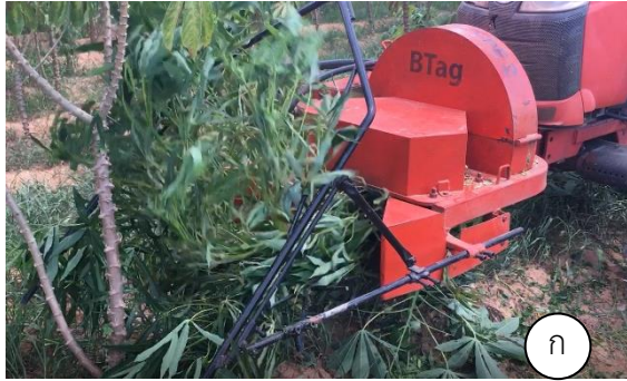
รูปที่ 18 เครื่องตัดและสับย่อยต้นมันสำปะหลังที่มีปัญหาการดูดต้น และส่วนของการขุดที่มีปัญหาการสะสมของเศษวัชพืช กิ่ง และต้น ซึ่งมีแนวทางแก้ไขได้แล้ว (ข)
