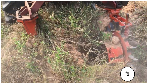
รูปที่ 18 เครื่องตัดและสับย่อยต้นมันสำปะหลังที่มีปัญหาการดูดต้น และส่วนของการขุดที่มีปัญหาการสะสมของเศษวัชพืช กิ่ง และต้น ซึ่งมีแนวทางแก้ไขได้แล้ว (ข)
