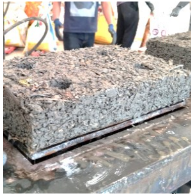
ภาพที่ 3.1.9 วัสดุปลูกกล้วยไม้ที่อัดขึ้นรูป
