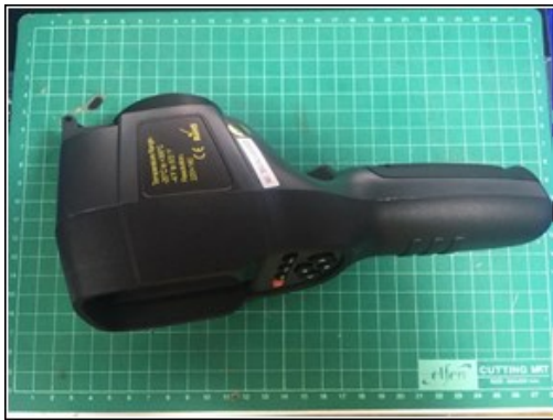
ภาพที่ 3.3.1 Thermal imaging camera
