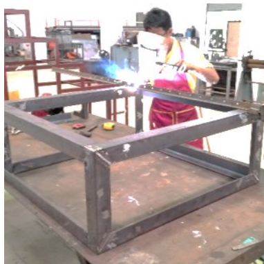
ภาพที่ 3.1.1 การประกอบขึ้นโครงสร้างเครื่องต้นแบบ
