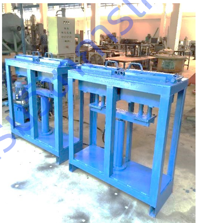
ภาพผนวกที่ 3.1.2 ต้นแบบเทคโนโลยีระดับภาคสนาม เครื่องผลิตวัสดุปลูกชีวภาพระดับเชิงพาณิชย์สำหรับกล้วยไม้
