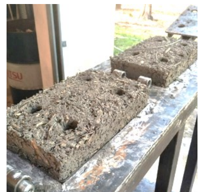
ภาพที่ 3.1.7 ก้อนวัสดุปลูกกล้วยไม้ที่ทดสอบอัด
