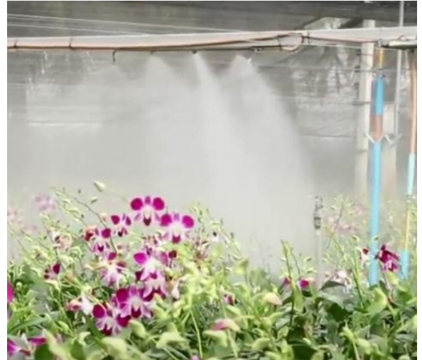
ภาพที่ 3.5 ระบบพ่นสารเคมีแบบแปรผันอัตราได้ที่ ติดตั้งในโรงเรือน
