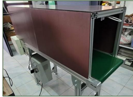
ภาพที่ 3.8 ชุดสายพานลำเลียงที่ประกอบด้วยห้องถ่ายภาพ
