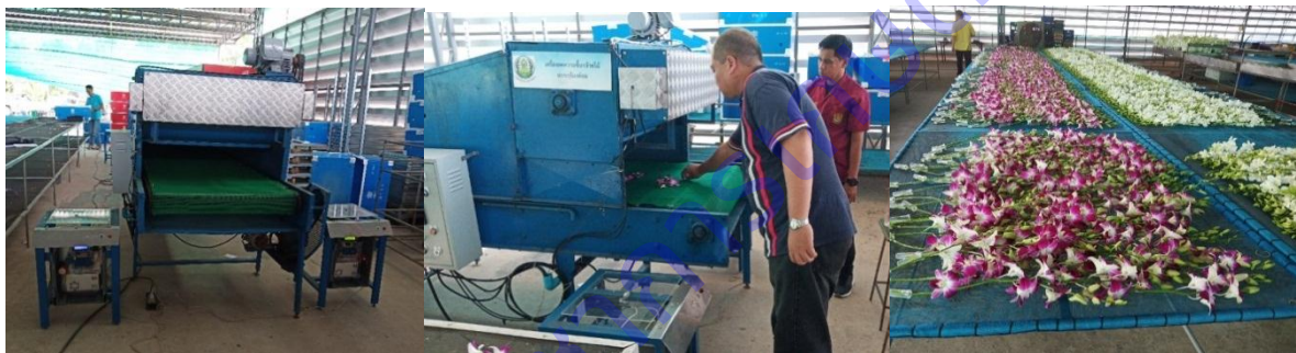
ภาพที่ 1.10 การทดสอบลดความชื้นของกล้วยไม้ด้วยเครื่องลดความชื้นกล้วยไม้อัจฉริยะและชุดตรวจสอบ
