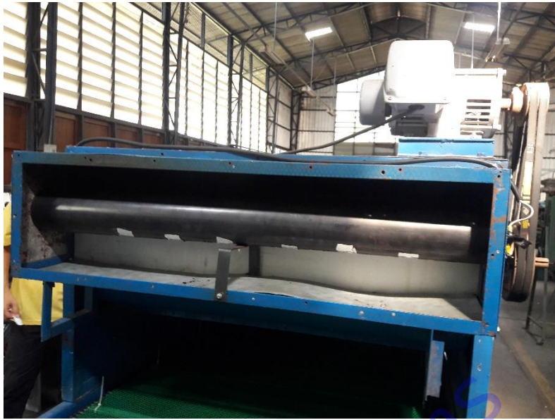
ภาพที่ 26 ติดตั้งอุปกรณ์ให้ความร้อนแบบฮีเตอร์ไฟฟ้าภายในตัวเครื่อง
