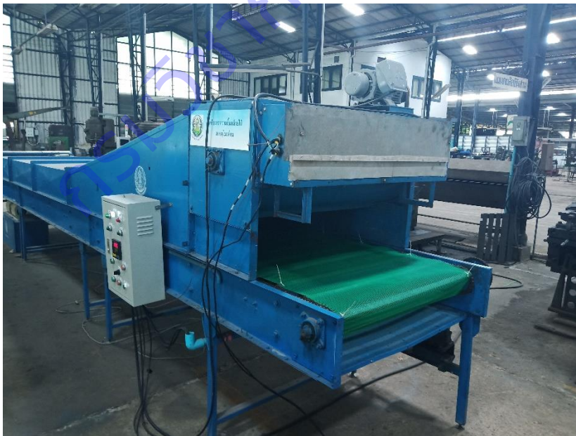
ภาพที่ 27 ตู้ควบคุมการทำงานของเครื่องลดความชื้นกล้วยไม้แบบอุโมงค์ลม
