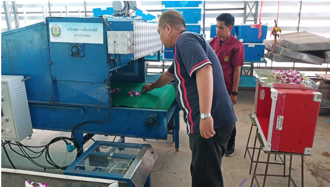
ภาพที่ 33 ทดสอบการลดความชื้นกล้วยไม้ด้วยเครื่องแบบอุโมงค์ลมและชุดตรวจสอบกล้วยไม้
