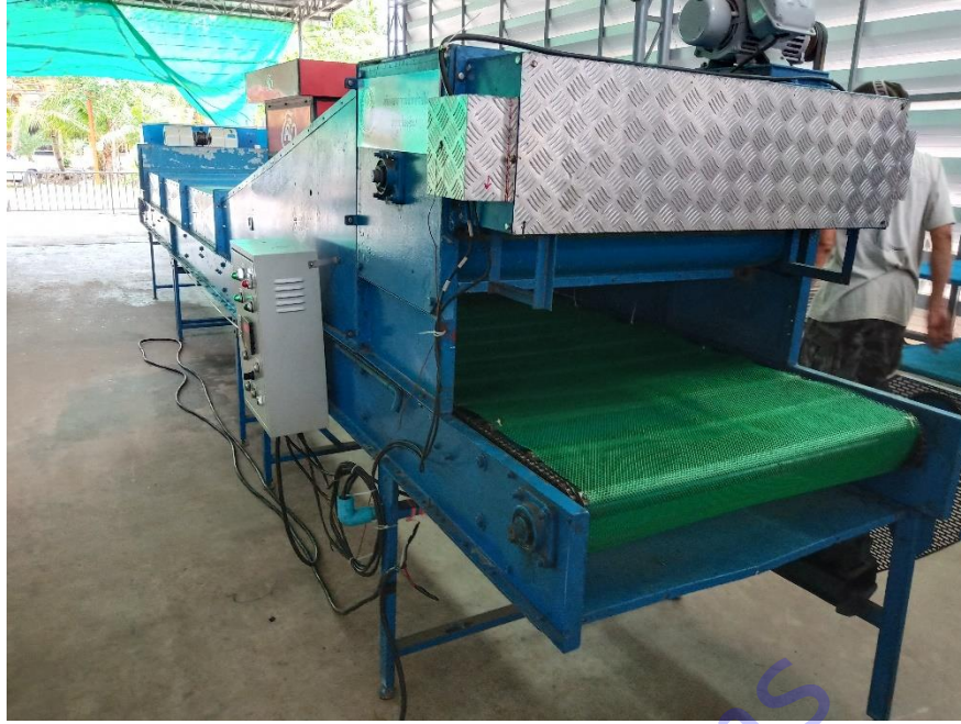
ภาพที่ 30 เครื่องลดความชื้นกล้วยไม้แบบอุโมงค์ลมพร้อมสำหรับการทดสอบใช้งานจริง
