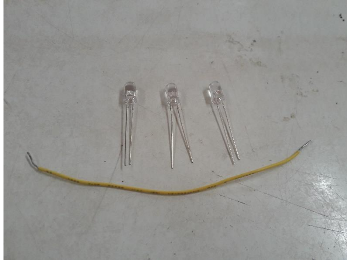
ภาพที่ 17 ลักษณะหลอด LED ที่ใช้ในการแสดงผล
