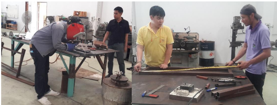
ภาพที่ 6 สร้างและประกอบโครงสร้างของชุดลำเลียงกล้วยไม้
