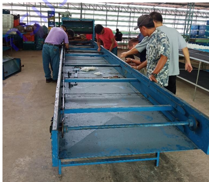
ภาพที่ 29 ติดตั้งประกอบเครื่องลดความชื้นกล้วยไม้แบบอุโมงค์ลม
