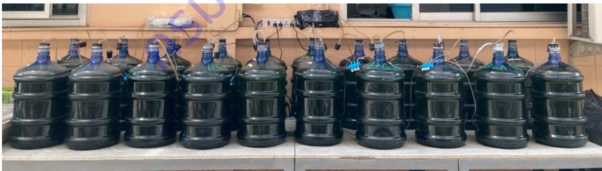
ภาพผนวกที่ 3 การเลี้ยงขยายชีวมวลสำหรับสายสีเขียวแกมน้ำเงินโดยใช้น้ำปุ๋ยหมักมูลไก่เจือจาง 250 เท่า และอาหารเหลว BG-11 0 ในถังพลาสติกขนาด 18.9 ลิตร ในสภาพโรงเรือน
