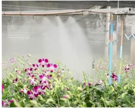
ภาพที่ 1 ระบบพ่นสารเคมีแบบแปรผันอัตราได้ที่ติดตั้งในโรงเรือน
