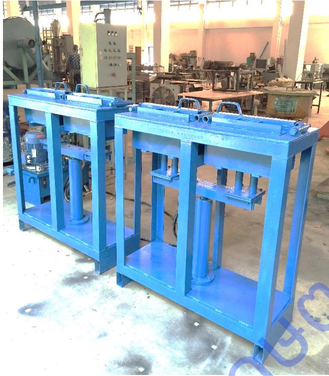
ภาพที่ 14 เครื่องผลิตวัสดุปลูกชีวภาพระดับเชิงพาณิชย์สำหรับกล้วยไม้
