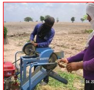
รูปที่ 4 การตัดท่อนพันธุ์โดยใช้แรงงานคน และเครื่องตัดท่อนพันธุ์ที่พัฒนาขึ้นเองในแต่ละพื้นที่
