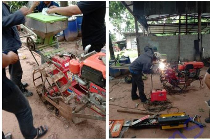
รูปที่ 14 การติดตั้งอุปกรณ์กำจัดวัชพืชและใส่ปุ๋ยของศูนย์วิจัยเกษตรวิศวกรรมเข้ากับรถไถเดินตามของเกษตรกร
