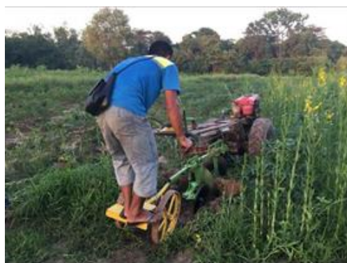
รูปที่ 13 ปัญหาการติดตั้งถึงปุ๋ย และการปรับปรุงแก้ไขเครื่องต้นแบบเพื่อเพิ่มประสิทธิภาพด้วยการเพิ่มอุปกรณ์ เพื่อลดความเหนื่อยล้าจากการเดิน
