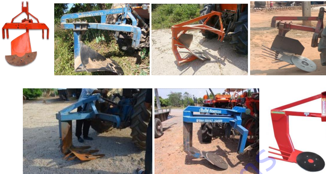
รูปที่ 12 ส่วนหนึ่งของผานขูดมันสำปะหลังในแต่ละภูมิภาคที่เกษตรกรใช้งานซึ่งมีหลากหลายรูปแบบมาก
