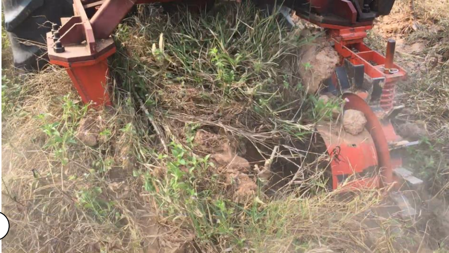
รูปที่ 18 เครื่องตัดและสับย่อยต้นมันสำปะหลังที่มีปัญหาการอุดตัน และส่วนของการขุดที่มีปัญหาการสะสมของเศษวัชพืช กิ่ง และต้น ซึ่งมีแนวทางแก้ไขได้แล้ว (ข)
