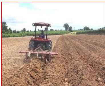
รูปที่ 3 การไถยกทรง ผานยกทรง (ก) และผานยกทรงมีโซ่ลากปาดสันร่อง (ข)
