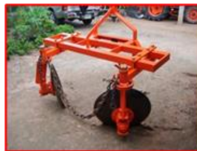
รูปที่ 3 การไถยกทรง ผานยกทรง (ก) และผานยกทรงมีโซ่ลากปาดสันร่อง (ข)
