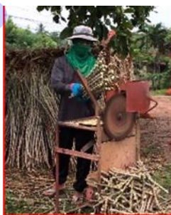
รูปที่ 4 การตัดท่อนพันธุ์โดยใช้แรงงานคน และเครื่องตัดท่อนพันธุ์ที่พัฒนาขึ้นเองในแต่ละพื้นที่
