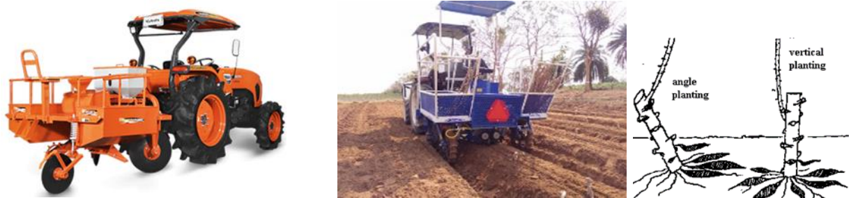
รูปที่ 6 เครื่องปลูกมันสำปะหลังแบบปักท่อนพันธุ์ในแนวตั้ง
