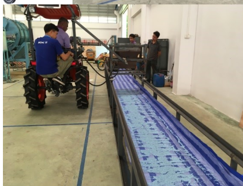
รูปที่ 14 ทดสอบลูกหยอดปุ๋ยในห้องปฏิบัติการ
