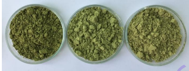
ภาพที่ 9 สีผงจากไบโเตยทำแห้งที่อุณหภูมิ 150 160 และ 170 °C
