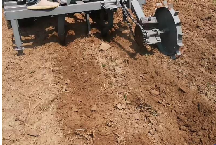
ภาพที่ 15 เพิ่มน้ำหนักและจำนวนฟันของกรรวิล
