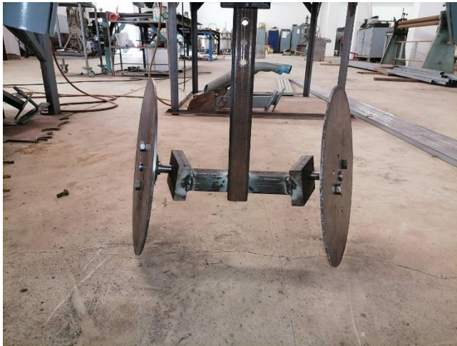
ภาพที่ 16 ติดตั้งตัวกลบหลุมปลูกระชับ
