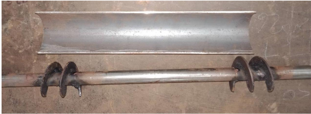
ภาพที่ 9 เกลียวสกรูเกลี่ยเมล็ดกระบี่ที่ใช้ในถังหยอดและรางสกรู
