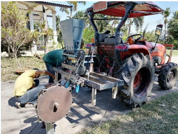
ภาพที่ 11 อุปกรณ์ต้นแบบต่อพ่วงกับแทรกเตอร์เกษตรกร
