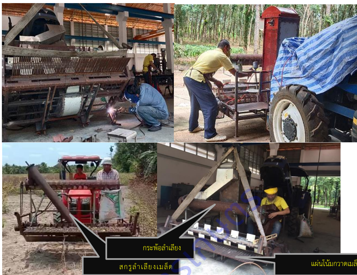
ภาพที่ 27 ปรับปรุงเครื่องเกี่ยวนวดกระซับหลังลงแปลงทดสอบเก็บข้อมูลแล้ว
