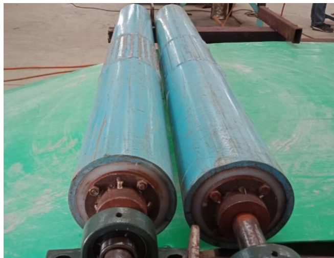
ภาพที่ 16 ประกอบและติดตั้งลูกกลิ้ง 2 ลูก
