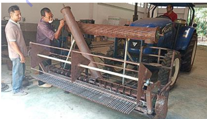
ภาพที่ 19 ประกอบอะไหล่และชิ้นส่วนต่างของเครื่องนวดกระชับส่วนด้านหน้ารถแทรกเตอร์
