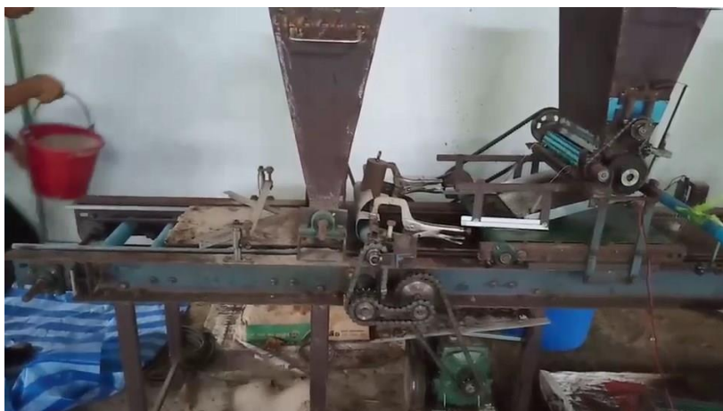
ภาพที่ 29 ทดสอบปลูกกระชับด้วยเครื่องปลูก (โรยเมล็ด กดเมล็ดและโรยทราย)
