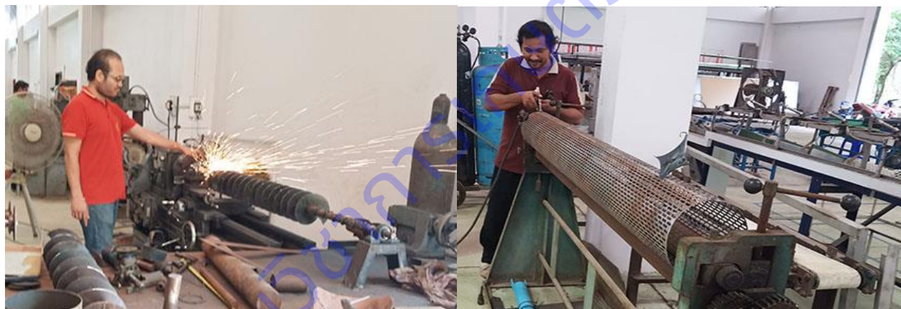
ภาพที่ 18 สกรูลำเลียง และกระบอกสกรูลำเลียงที่ทำหน้าที่เป็นผนังห้องนวดและทำความสะอาด
