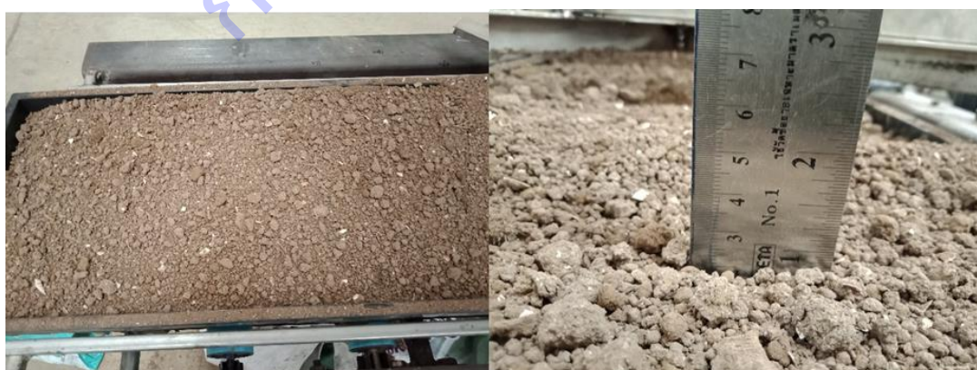
ภาพที่ 25 ชุดโรยดินลงถาดความหนาใกล้เคียง 25 มิลลิเมตร
