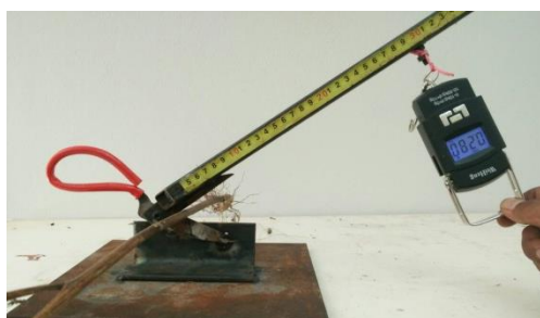
ภาพที่ 12 เครื่องมือทดสอบแรงตัดแบบกรรไกร
