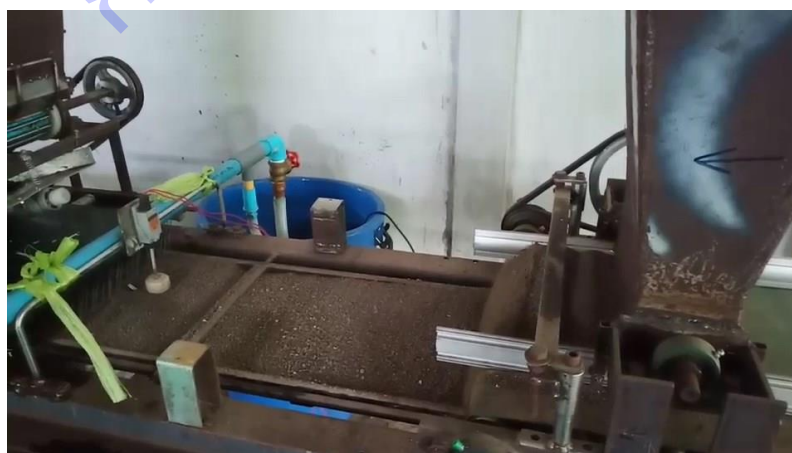
ภาพที่ 28 ทดสอบปลุกกระซับด้วยเครื่องปลุก(โรยดินและรดน้ำ)
