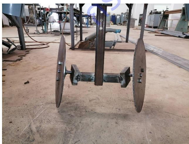
ภาพที่ 16 ติดตั้งตัวกลบหลุมปลูกกระชับ
