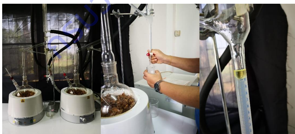
ภาพที่ 8 การสกัดน้ำมันจากว่านนางคำฝานอบแห้ง
