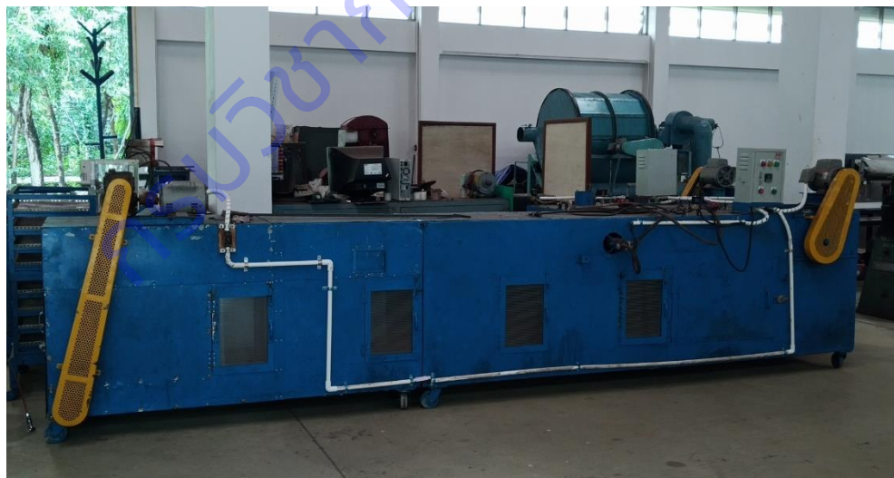
ภาพที่ 2 เครื่องอบแห้งลมร้อนที่แก้ไขปรับปรุงสมบูรณ์
