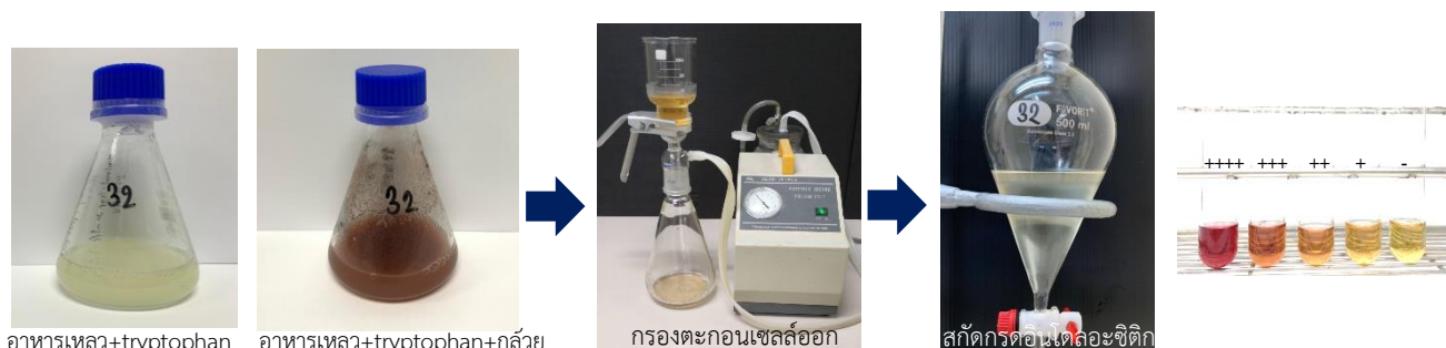
ภาพที่ 1-15 กรรมวิธีการผลิตกรดอินโดลอะซีติกและการสกัดสารให้บริสุทธิ์
