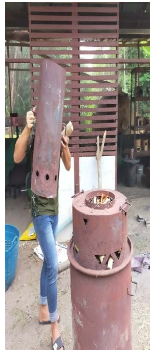
ภาพผนวกที่ 3ค ขั้นตอนเตรียมตัวอย่างชีวมวลอัดแท่ง “เผาให้เป็นถ่านด้วยเตาถังน้ำมัน 200 ลิตรแบบเตาไร่คว้น”
