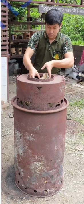
ภาพผนวกที่ 3ค ขั้นตอนเตรียมตัวอย่างชีวมวลอัดแท่ง “เผาให้เป็นถ่านด้วยเตาถังน้ำมัน 200 ลิตรแบบเตาไร่คว้น”
