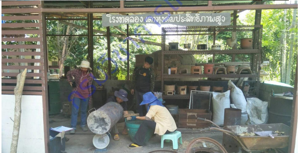
รูปผนวกที่ 2ค ขั้นตอนเตรียมตัวอย่างชีวมวลอัดแท่ง “นำลำไผ่มาเลื่อยเป็นท่อนๆขนาด 10-15 เซนติเมตร”
