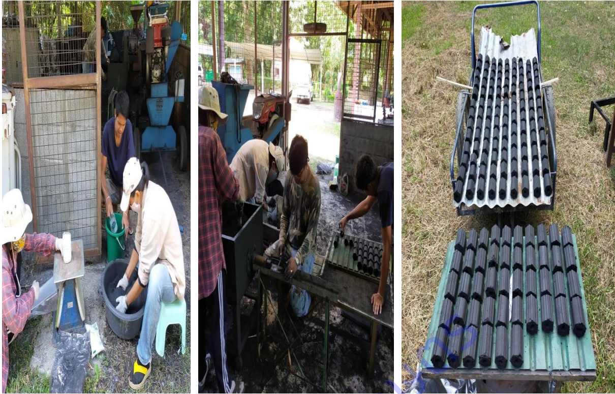
รูปผนวกที่ 5ค ขั้นตอนเตรียมตัวอย่างชีวมวลอัดแท่ง “อัดให้เป็นแท่งด้วยเครื่องอัดแท่งเชื้อเพลิงแข็งแบบอัดเย็น”
