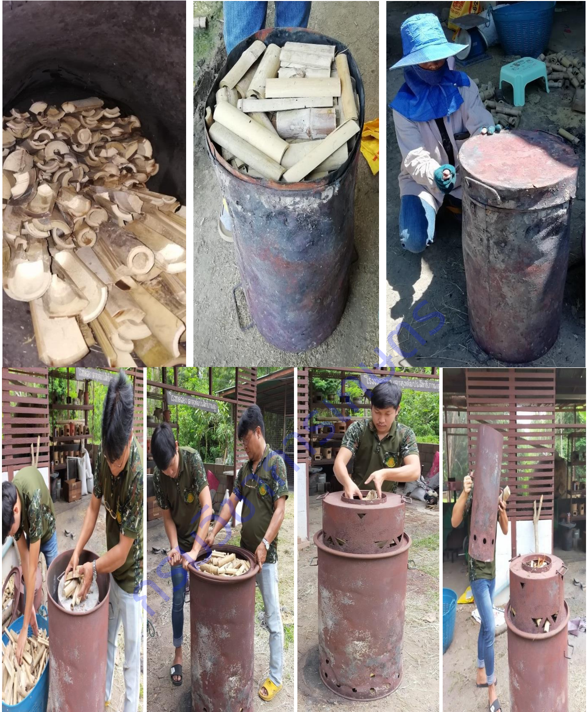
รูปผนวกที่ 3ค ขั้นตอนเตรียมตัวอย่างชีวมวลอัดแท่ง “เผาให้เป็นถ่านด้วยเตาถังน้ำมัน 200 ลิตรแบบเตาไร่ควน”
