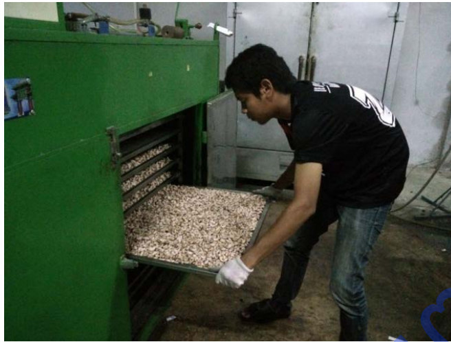
ภาพที่ 15 ทำการทดสอบในห้องทดลองด้วยเครื่องอบแห้งลมร้อนของสถาบันวิจัยเกษตรวิศวกรรม
