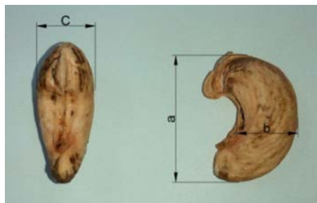
ภาพที่ 2 การวัดหาขนาดเมล็ดมะม่วงหิมพานต์ก่อนกะเทาะ
