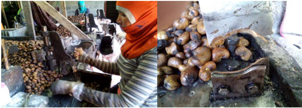
ภาพที่ 6 เครื่องกะเทาะเปลือกแข็งเมล็ดมะม่วงหิมพานต์แบบเท้าเหยียบ
