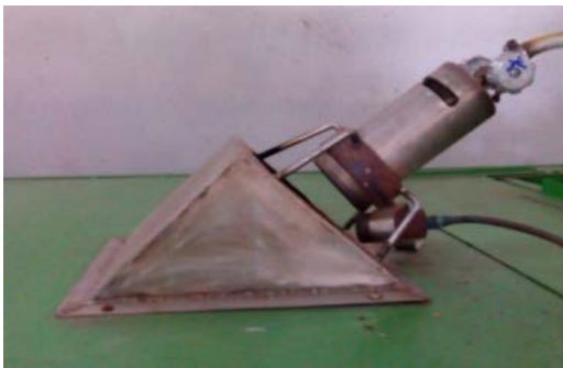
ภาพที่ 30 หัวเผาแก๊สและหัวล่อแก๊สแบบเก่า
