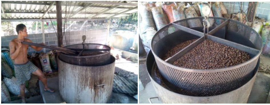
ภาพที่ 3 ต้มเมล็ดมะม่วงหิมพานต์ในน้ำเดือด ครึ่งชั่วโมง
