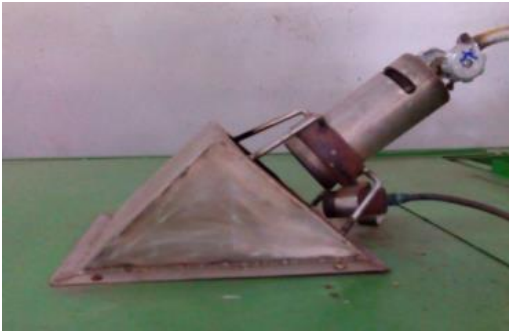
ภาพที่ 28 หัวเผาแก๊สและหัวล่อแก๊สแบบเก่า
