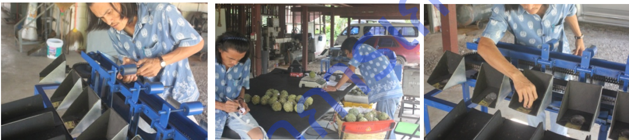
ภาพที่ 14 การปรับตั้งสถานีซึ่งน้ำหนักเครื่องตัดแยกขนาดผลผลิตน้อยหน้าตามน้ำหนักมาตรฐาน
