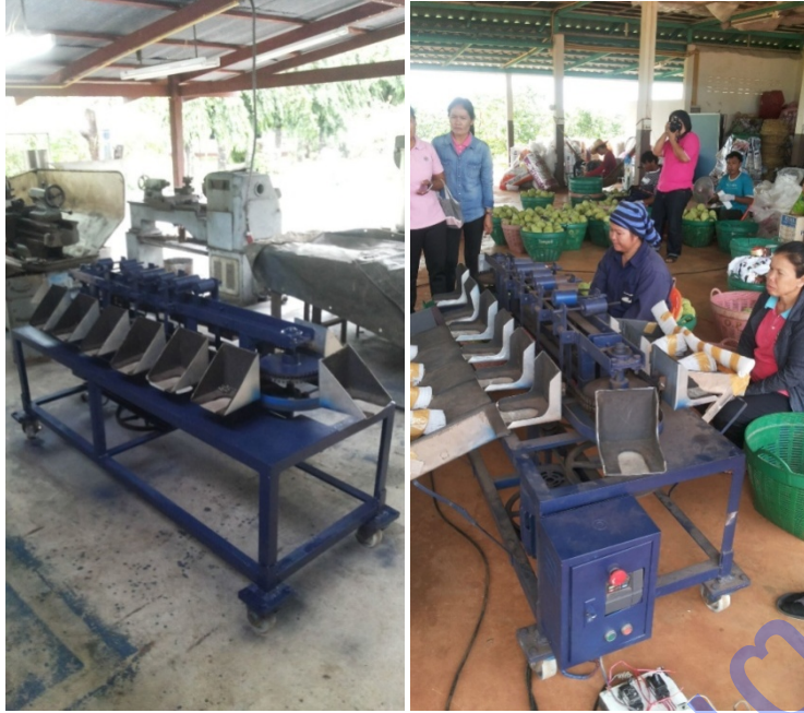
ภาพที่ 11 เครื่องต้นแบบที่ 1 เครื่องคัดแยกขนาดผลผลิตน้อยหน้าโดยใช้น้ำหนัก
