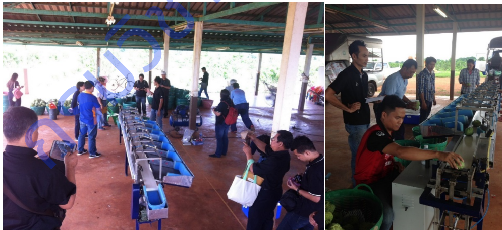
ภาพที่ 17 การทดสอบเครื่องคัดขนาดผลน้อยหน้าต้นแบบที่ ในจุดรวบรวมผลผลิตเพื่อคัดบรรจุ ของเกษตรกร
