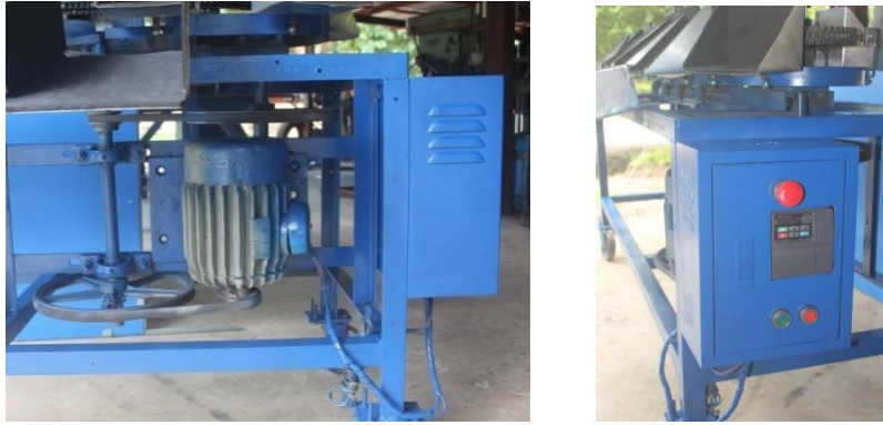
ภาพที่ 13 แสดงชุดควบคุมความเร็วในการตัดแยก และมอเตอร์ต้นกำลัง
