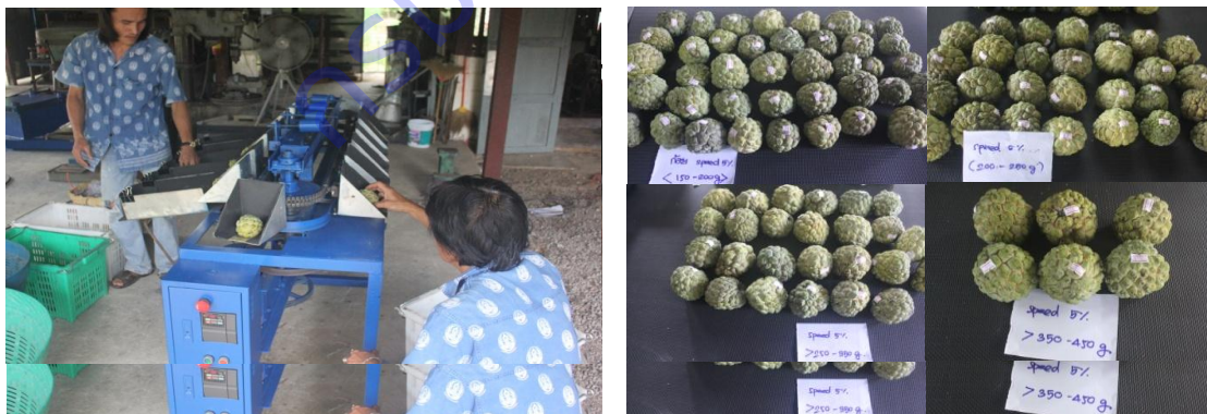
ภาพที่ 15 การทดสอบเครื่องตัดแยกขนาดผลผลิตน้อยหน้าโดยน้ำหนัก(ซ้าย)และผลน้อยหน้าจากการคัดแยก โดยเครื่องตัดแยกขนาดผลผลิตน้อยหน้าโดยน้ำหนัก(ขวา)
