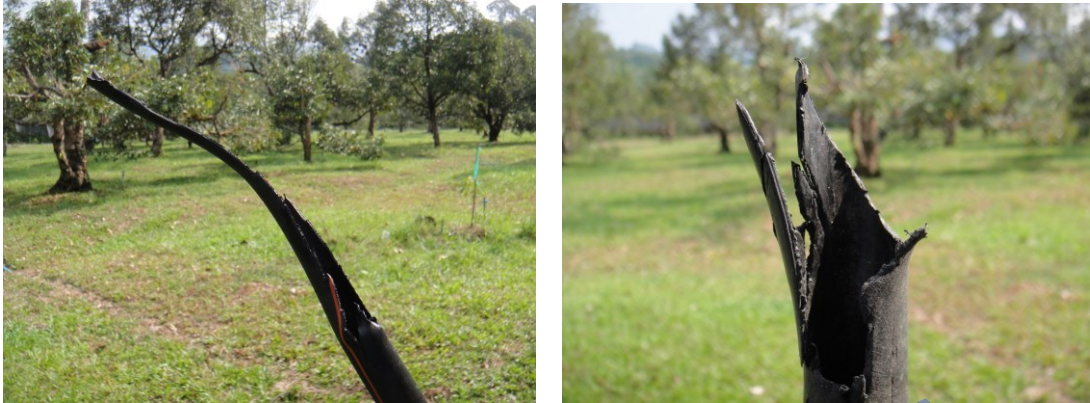
ภาพที่ 6 ท่อ PE ในศูนย์วิจัยพืชสวนจันทบุรีที่ถูกเครื่องตัดหญ้าข้ออ่อนตัดเสียหาย
