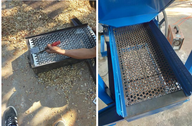
ภาพที่ 8.12 ลักษณะตะแกรงที่เหมาะสมต่อการทำความสะอาดซึ่งสามารถเปลี่ยนได้ตามขนาด เมล็ดพันธุ์
