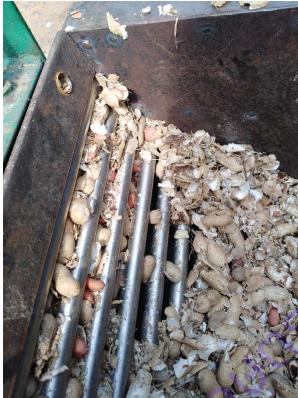
ภาพที่ 8.5 เครื่องเดิมจำเป็นต้องปรับปรุงช่องทางออกที่แคบทำให้เมล็ดข้าวติด
