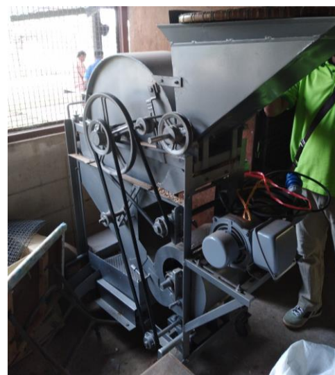
ภาพที่ 6.4 เครื่องกะเทาะถั่วลิสงแบบล้อยางติดมอเตอร์
