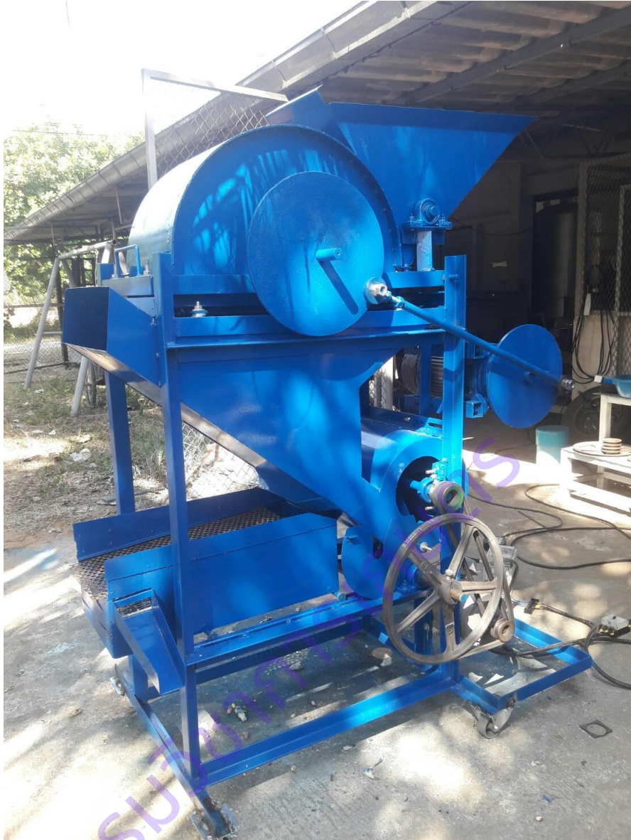
ภาพที่ 8.13 ต้นแบบของเครื่องกะเทาะถั่วลิสงแบบล้ออย่างที่ใช้การกะเทาะแบบหมุนไป-กลับ
