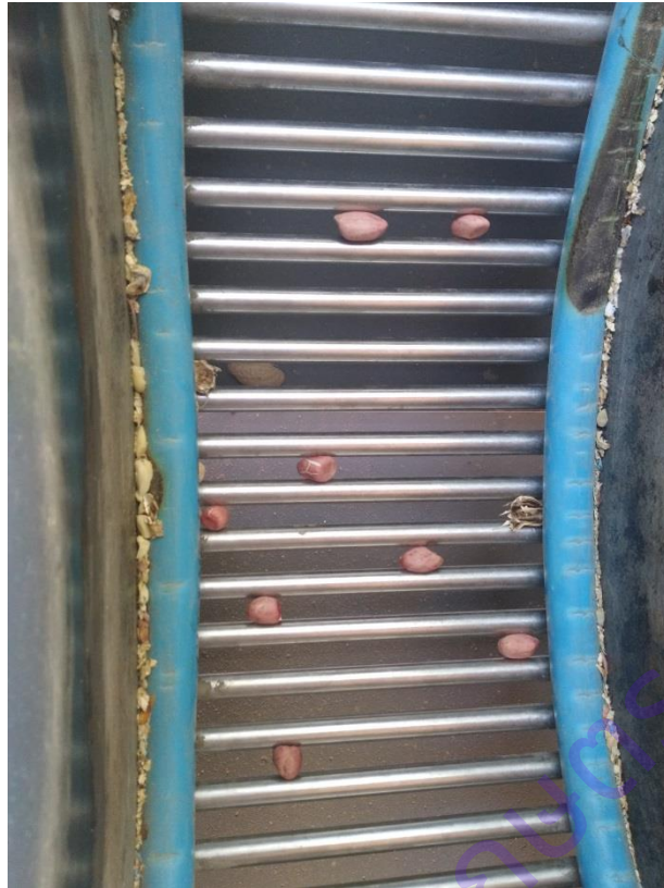
ภาพที่ 8.10 การปิดช่องตะแกรงเพื่อเพิ่มประสิทธิภาพการกะเทาะเนื่องจากบริเวณด้านข้างของล้อมีลักษณะโค้ง ไม่สัมผัสเมล็ดถั่ว
