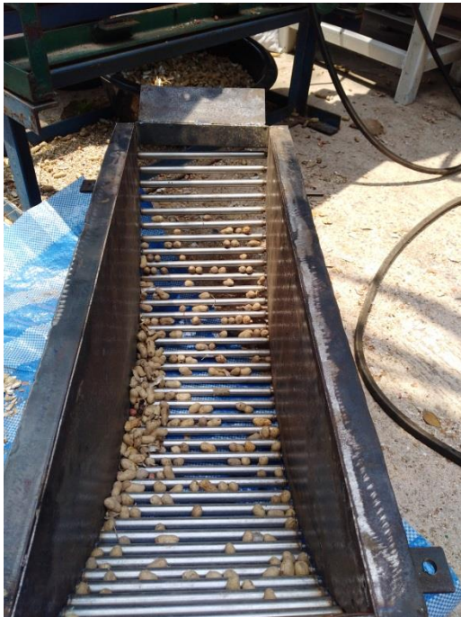
ภาพที่ 8.3 ตะแกรงที่จะใช้ในการทดสอบแบบใหม่มีกระบอกหมุน
