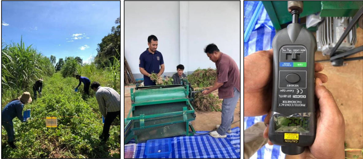
ภาพที่ 6 เก็บเกี่ยวข้าวลิสงฝักขนาดเล็ก พันธุ์ไทนนาน 9 และทดสอบการปลดฝักข้าวลิสงด้วยเครื่องปลดตามความเร็วรอบที่กำหนด
