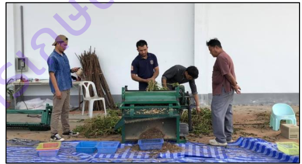
ภาพที่ 6 เก็บเกี่ยวข้าวลิสงฝักขนาดเล็ก พันธุ์ไทนนาน 9 และทดสอบการปลดฝักข้าวลิสงด้วยเครื่องปลดตามความเร็วรอบที่กำหนด
