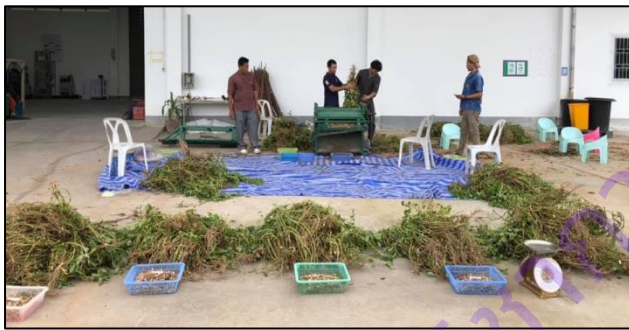
ภาพที่ 6 เก็บเกี่ยวข้าวลิสงฝักขนาดเล็ก พันธุ์ไทนนาน 9 และทดสอบการปลดฝักข้าวลิสงด้วยเครื่องปลดตามความเร็วรอบที่กำหนด
