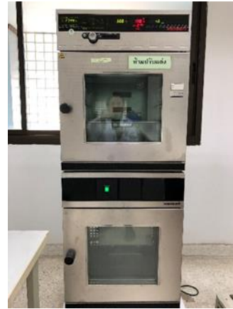
(ง) ทำให้แห้งด้วย vacuum oven ภายใต้สุญญากาศ
