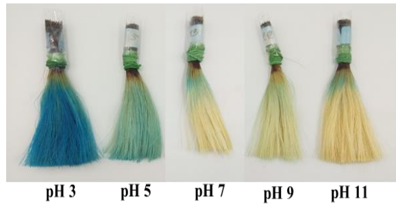
ภาพที่ 7.6 ลักษณะสีของตัวอย่างผมที่ย้อมด้วยอินดิโก้คาร์มินจากอินดิโก้จากห้อมในสารละลายบัฟเฟอร์ pH ต่างๆ
