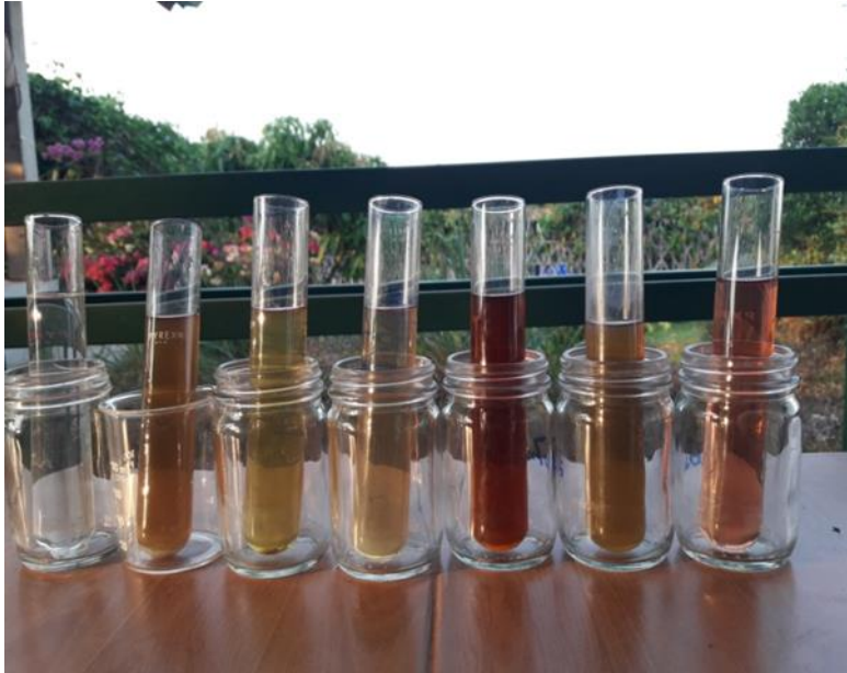
ภาพที่ 4.2 สี และความเป็นกรด-ด่างของน้ำต้มสารช่วยติดจากเปลือกและใบพืชชนิดต่างๆ
