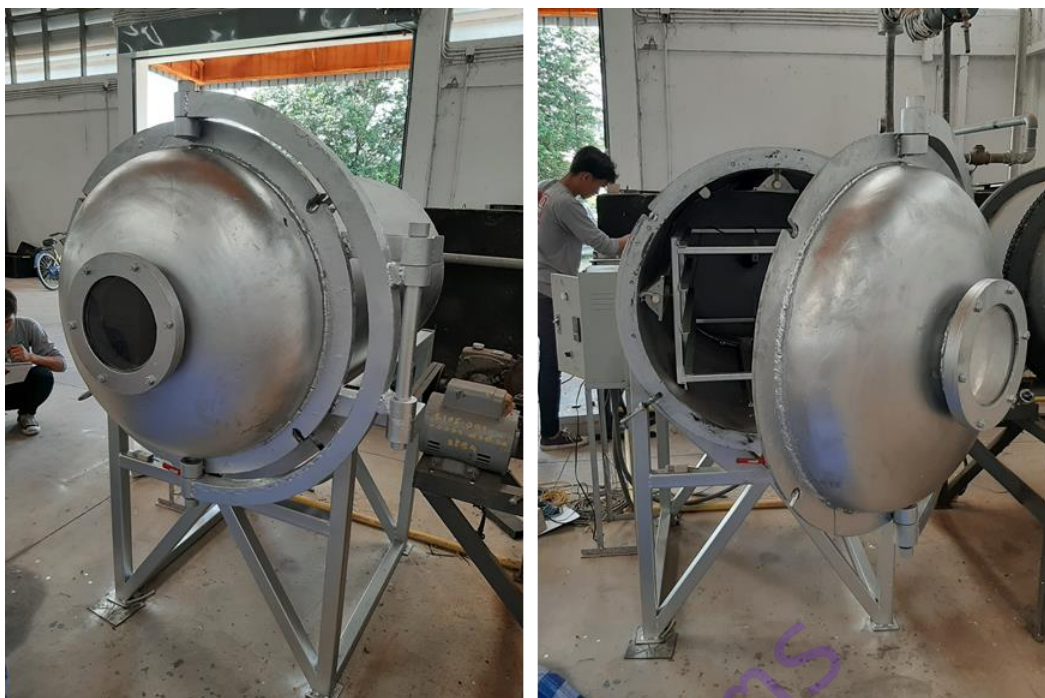
ภาพที่ 11 ฝา เปิด-ปิด ถังอบแห้งแบบลดแรงดันอากาศที่เสร็จสมบูรณ์แล้ว
