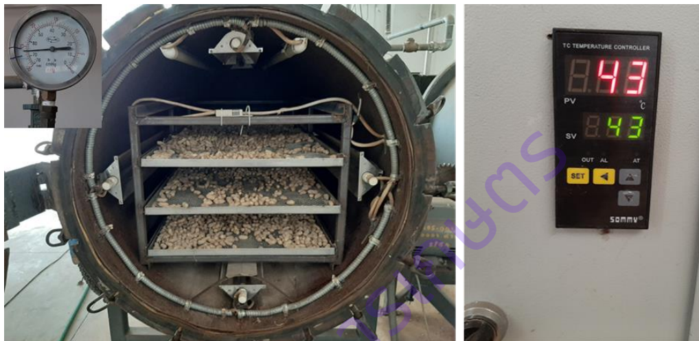
ภาพที่ 15 การทดสอบอบลดความชื้นฝักถั่วลิสงด้วยเครื่องอบลดแรงดันอากาศ
