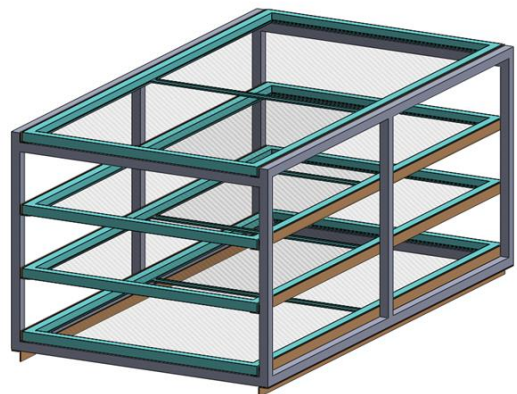
ภาพที่ 4 แบบชั้นวางและถาดตะแกรงสำหรับใส่เมล็ดพันธุ์ถั่วเหลืองบรรจุในถังอบแห้งสุญญากาศ
