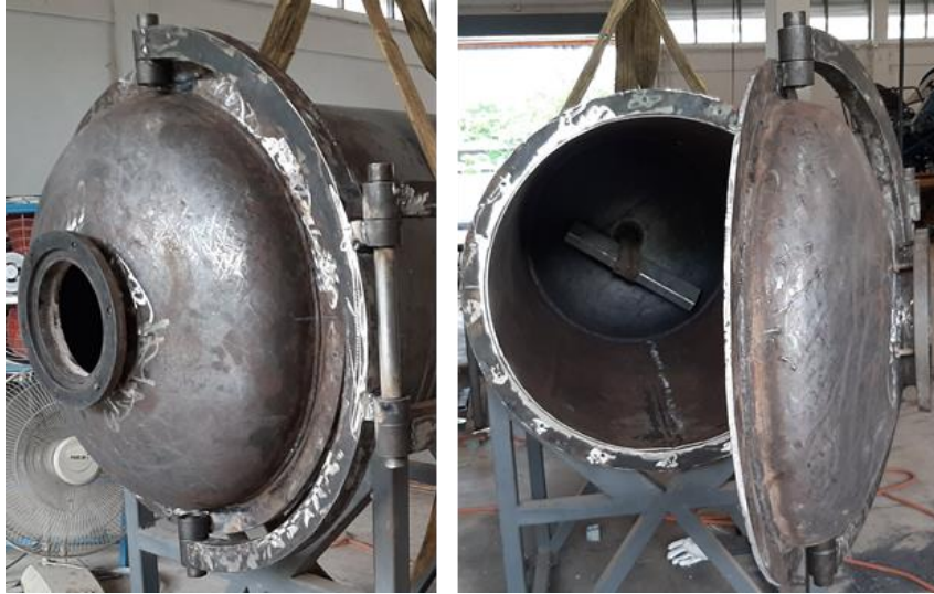
ภาพที่ 8 ชั้นสุตรองรับการหมุน เปิด-ปิด ฝาถังอบแห้งสุญญากาศ
