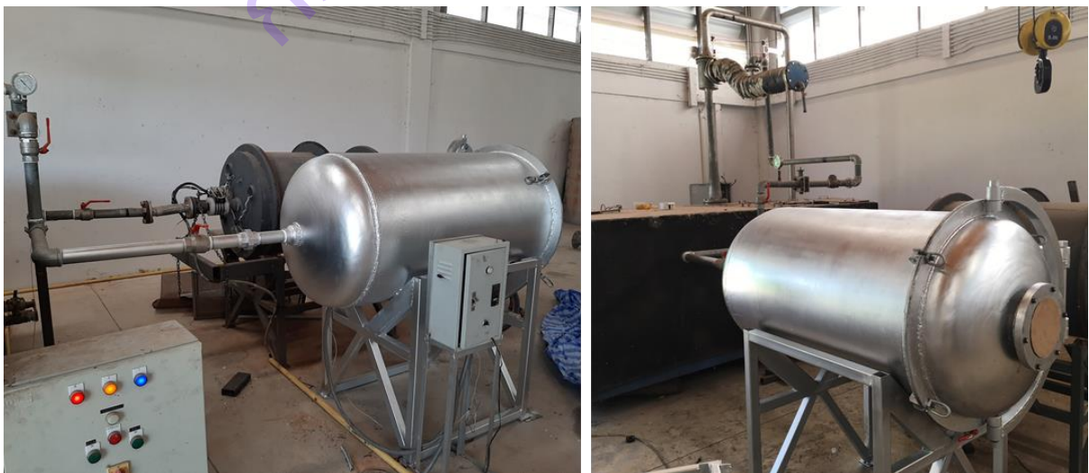
ภาพที่ 10 ด้านนอกของถังอบแห้งแบบลดแรงดันอากาศที่สร้างเสร็จสมบูรณ์แล้ว
