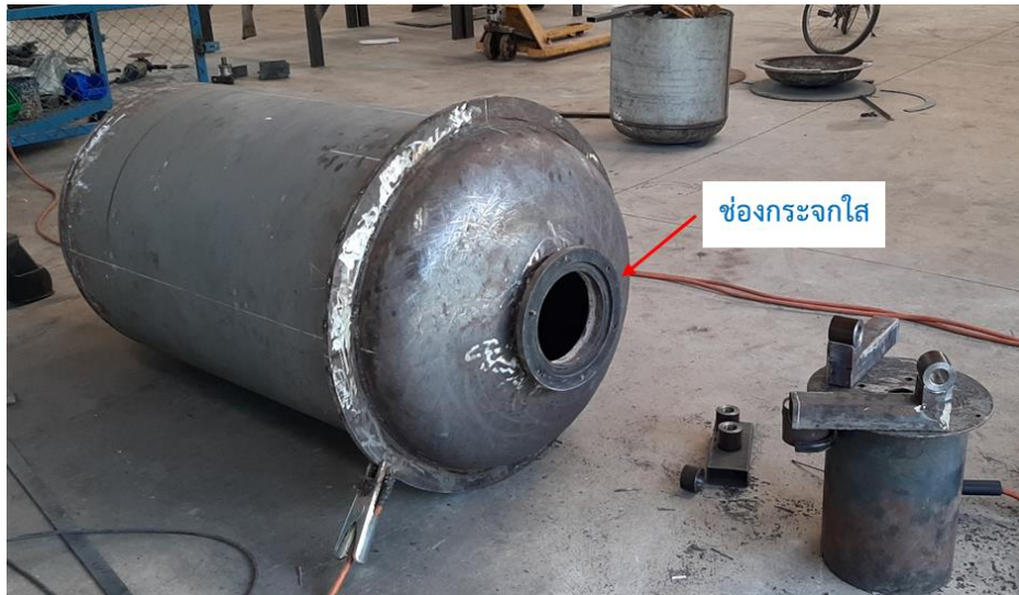
ภาพที่ 6 ถังอบแห้งสุญญากาศทรงกระบอก มีช่องมองผลิตภัณฑ์เป็นช่องกระจกใส
