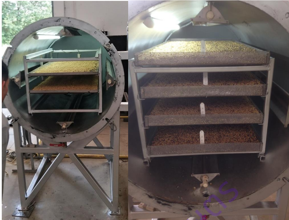
ภาพที่ 13 การบรรจุเมล็ดถั่วเหลืองในภาควางของเครื่องอบแห้งลดแรงดันอากาศ
