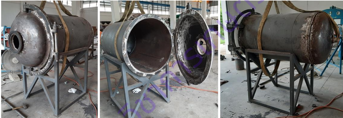
ภาพที่ 9 การติดตั้งถังอบสุญญากาศบนฐานตั้งรับถัง
