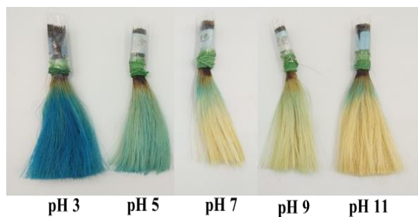
ภาพที่ 7.8 ลักษณะสีของตัวอย่างผมที่ย้อมด้วยอินดิโก้คาร์มีนจากอินดิโก้จากห้อมในสารละลายบัฟเฟอร์ pH ต่าง ๆ
