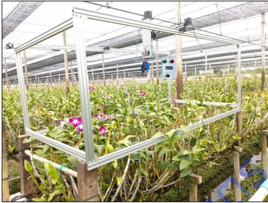
ภาพที่ 2 ระบบตรวจสอบเพลิงไฟ และบักกล้วยไม้ที่ติดตั้งในโรงเรือน
