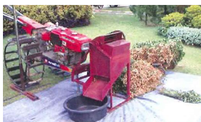
ภาพที่ 32 แสดงลักษณะการทำงานของการนวดถั่วลิสงเมล็ดโต
