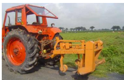
ภาพที่ 7 เครื่องขุดดินกล้วยไม้รุ่น DL -0.3
