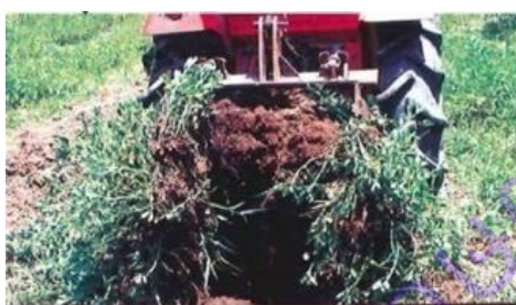
ภาพที่ 15 แสดงลักษณะการทำงานของเครื่องขุดถั่วลิสงเมล็ดโต
