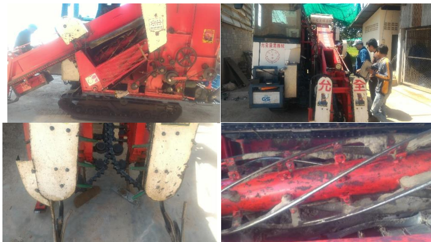
ภาพที่ 44 ใบชุด และโซ่หนีบต้นข้าว และชุดปลิดฝัก ของเครื่องขุดข้าวลิสงจากไต้หวัน
