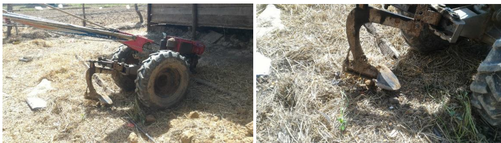
ภาพที่ 40 เครื่องซุดเก็บถั่วลิสงของเกษตรกรในพื้นที่ ต.นาเลียง รายที่ 2
