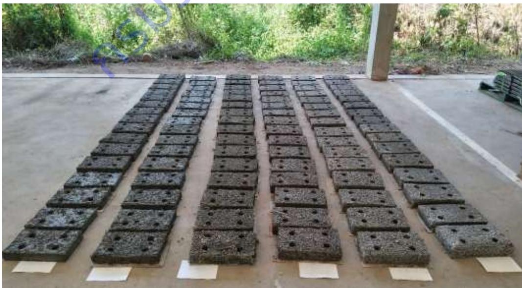
ภาพที่ 13 ก้อนวัสดุปลูกกล้วยไม้พร้อมสำหรับการทดลองปลูกกล้วยไม้
