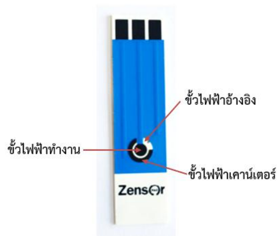
ภาพที่ 16 ขั้วไฟฟ้าพิมพ์สกรีนคาร์บอน (Screen printed carbon electrode; SPCE) แบบ 3 ขั้ว ได้แก่ ขั้วไฟฟ้าทำงาน ขั้วไฟฟ้าเคาน์เตอร์ และขั้วไฟฟ้าอ้างอิง
