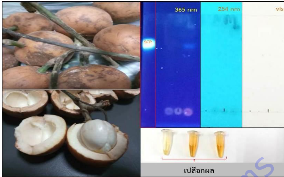
ภาพที่ 21 ลังแข ( Baccaurea macrophylla Muell. Arg.) และการแยกสารสกัดเอทานอลของเปลือกผลที่ความเข้มข้น 1.57 กรัมน้ำหนักแห้งต่อมิลลิลิตร ด้วยเทคนิค TLC เทียบกับสารสคอพอเลติน(scp) ภายใต้แสงยูวีที่ 365 นาโนเมตร 254 นาโนเมตร และแสง visible
