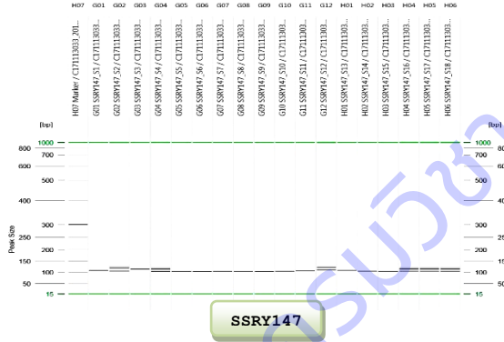
ภาพที่ 4 แสดงรูปแบบแถบดีเอ็นเอที่ได้จากการทำปฏิกิริยา PCR ของมันสำปะหลัง 18 พันธุ์ ร่วมกับไพรเมอร์ชนิด SSR ได้แก่ SSRY4, SSRY20, SSRY21, SSRY51, SSRY59, SSRY141, SSRY147 และ SSRY148 วิเคราะห์ผลด้วยเครื่อง QIAxcel Advanced System
