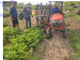
ภาพที่ 2.5 การสิ้นเปลืองของแทรกเตอร์ และการทดสอบเครื่องต้นแบบในแปลงปลูกถั่วลิสง
