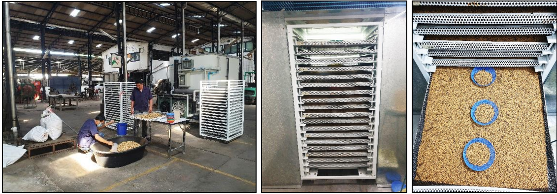
ภาพผนวกที่ 3 การเตรียมเมล็ดพันธุ์ธัญพืชก่อนการลดความชื้น ในเครื่องอบแบบป้อนความร้อน ณ สถาบันวิจัยเกษตรวิศวกรรม กรมวิชาการเกษตร กรุงเทพฯ
