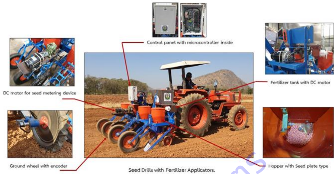
ภาพผนวกที่ 1 เครื่องหยอดเมล็ดพืชและปุ๋ยแบบอัตโนมัติที่ควบคุมอัตราการหยอดด้วยสมองกลฝังตัว และส่วนประกอบของเครื่องต้นแบบ
