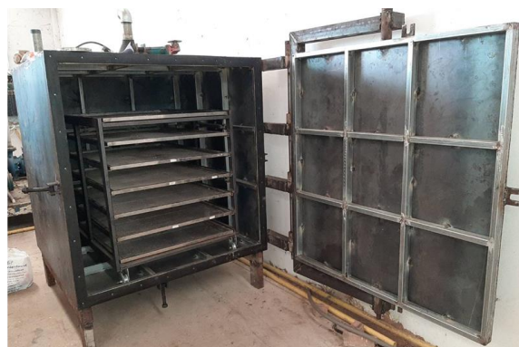
ภาพที่ 4.3 ห้องอบแห้งรูปทรงสี่เหลี่ยม ขนาด กว้าง x ยาว x สูง 1.20 x 1.20 x 1.20 เมตร หรือคิดเป็นปริมาตร 1.73 ลูกบาศก์เมตร
