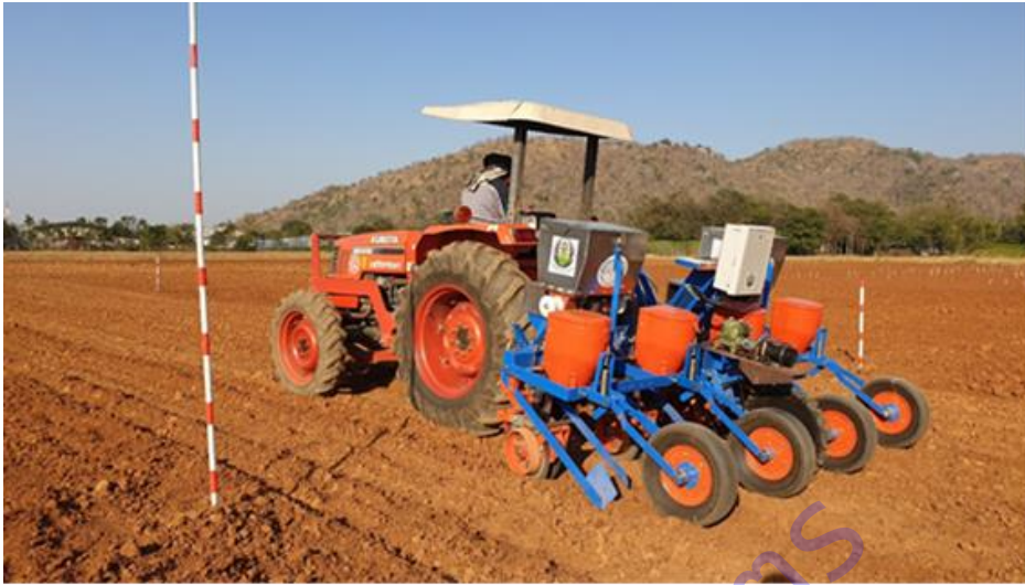
ภาพที่ 1.1 การทดสอบเครื่องหยอดเมล็ดพืชและปุ๋ยแบบอัตโนมัติในแปลงทดสอบ
