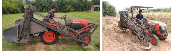
ภาพที่ 2.4 เครื่องต้นแบบที่มีขาชุดแบบไม่สั้น และแบบมีขาชุดแบบสั้น
