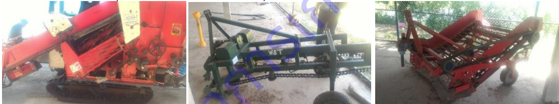
ภาพที่ 2.2 เครื่องขุดถั่วลิสงจากไต้หวัน เครื่องขุดถั่วลิสงแบบมีโซ่หนีบต้นถั่ว และแบบสะพานลำเลียงต้นถั่ว
