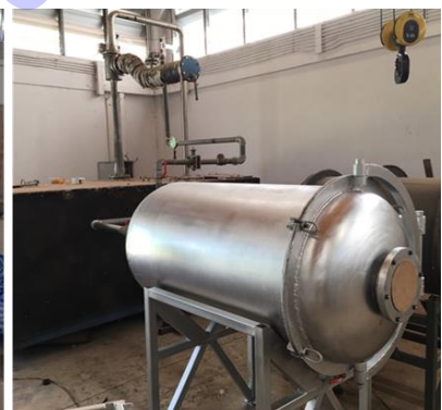
ภาพที่ 4.2 เครื่องอบแบบลดแรงดันอากาศ ห้องอบรูปทรงกระบอก เส้นผ่าศูนย์กลาง 0.75 เมตร
