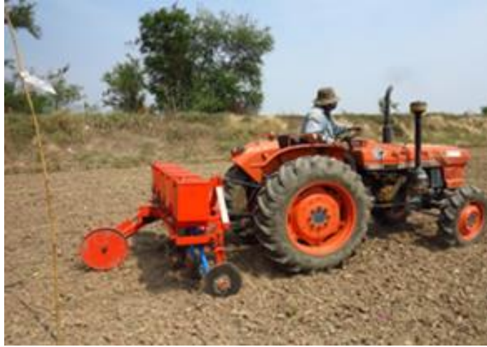
ภาพที่ 1.6 เครื่องหยอดพืชหลังนาติดพวงท้ายรถแทรกเตอร์ ที่มา: ยุทธนาและคณะ (2556ข)
