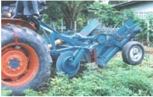
ภาพที่ 2.4 เครื่องเก็บเกี่ยวถั่วลิสงฟางทำรถแทรกเตอร์ แบบใบมีดชุด แยกดินและโรยตาก
