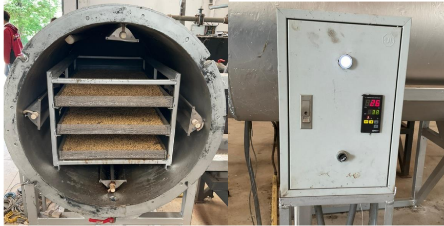
ภาพที่ 4.20 นำถาดเมล็ดพันธุ์ถั่วเหลืองเข้าเครื่องอบลดแรงดันอากาศ ตั้งอุณหภูมิ 38 องศาเซลเซียส
