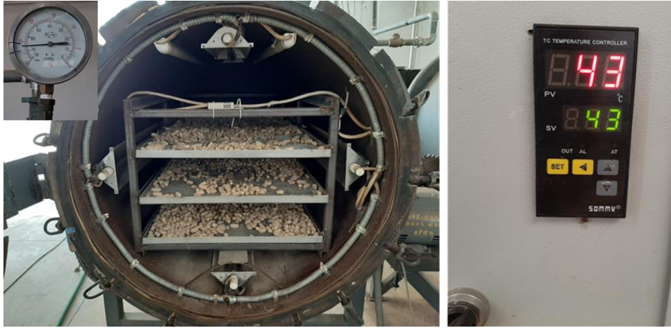
ภาพที่ 1.10 การทดสอบอบลดความชื้นฝักถั่วลิสงด้วยเครื่องอบลดแรงดันอากาศ
