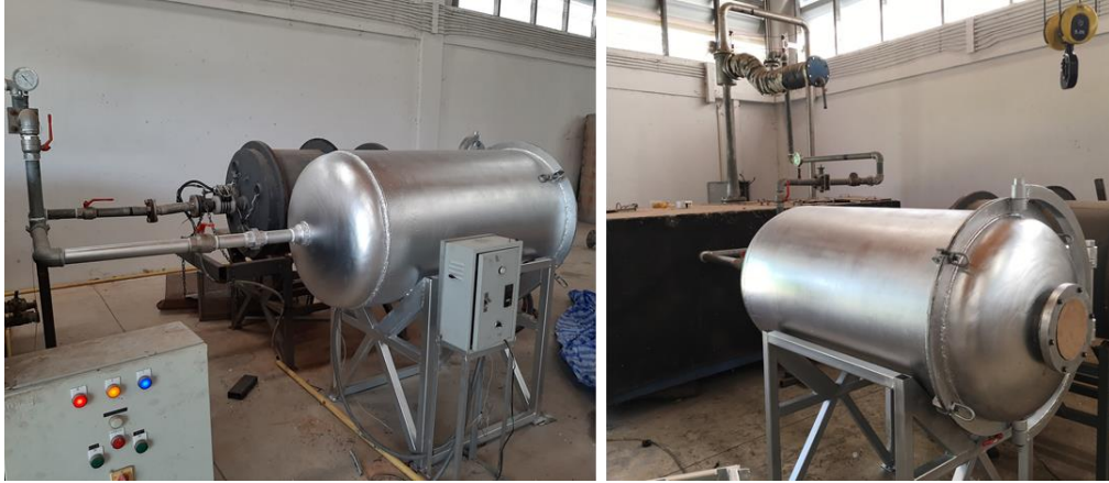
ภาพที่ 4.8 การประกอบถังอบแห้งกับปั๊มสุญญากาศ water jet ที่สร้างเสร็จสมบูรณ์แล้ว
