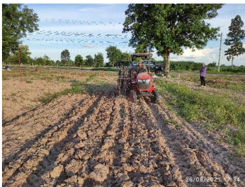
ภาพที่ 2.30 การทดสอบและผลทดสอบการสิ้นเปลืองของแทรกเตอร์
