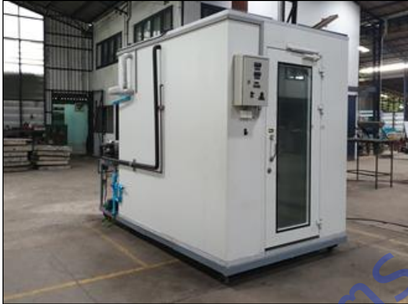
ภาพผนวกที่ 3.5 ต้นแบบเครื่องลดความชื้นแบบปั๊มความร้อน (ด้านหน้า)
