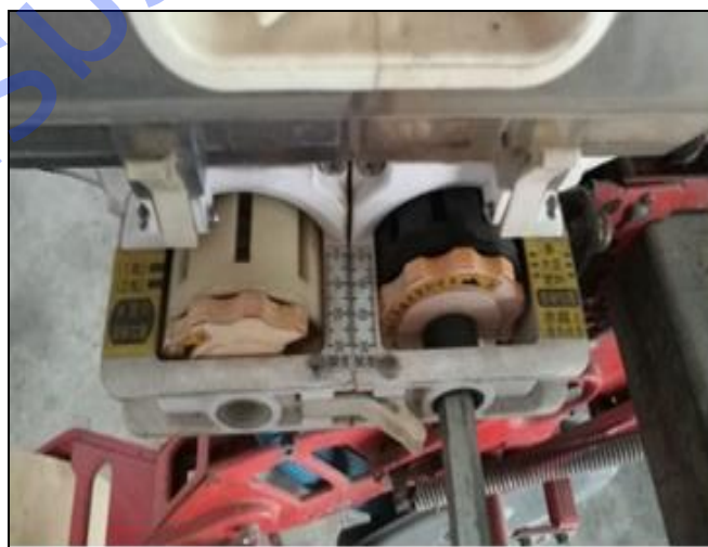
ภาพที่ 1.4 สกรูปรับขนาดล้อรองของรูดเมล็ด (ซ้าย) และสกรูปรับขนาดล้อรองของรูดพุ่ม (ขวา)
