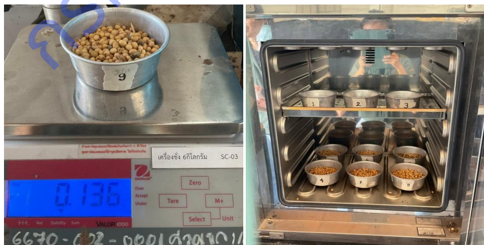
ภาพที่ 4.19 การหาความชื้นเริ่มต้น-สุดท้าย ของเมล็ดพันธุ์ถั่วเหลืองโดยตู้อบลมร้อน
