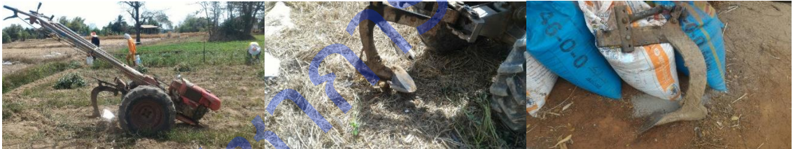
ภาพที่ 2.13 เครื่องขุดเก็บถั่วลิสงของเกษตรกรในพื้นที่ ต.นาเลียง อ.นาแก จ.นครพนม
