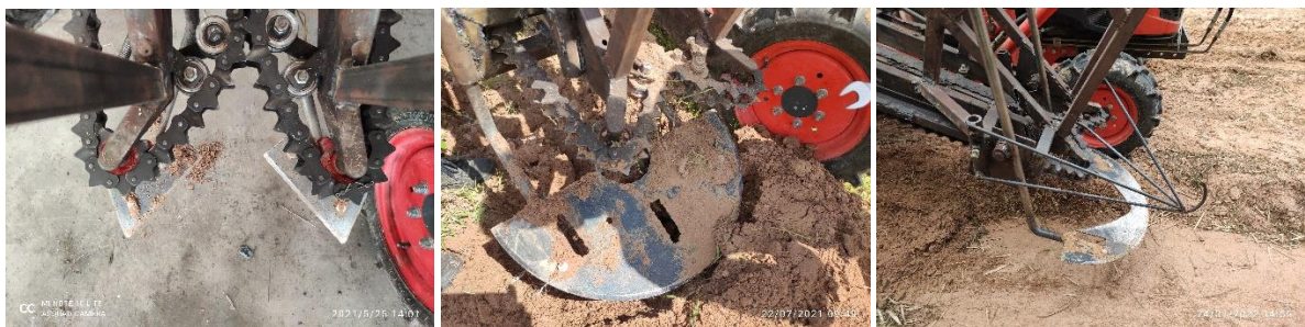
ภาพที่ 2.28 ฝักชุดแบบใบมีด แบบฝักคัตท้ายแทรกเตอร์ผ่าครึ่งวงกลม ไม่เจาะและเจาะช่องคายดินกลางฝัก
