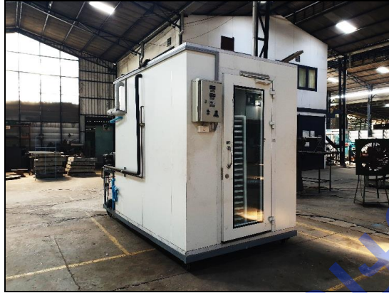
ภาพที่ 3.9 ผลการสร้างเครื่องต้นแบบตู้ลดความชื้นเมล็ดพันธุ์ถั่วเหลือง
