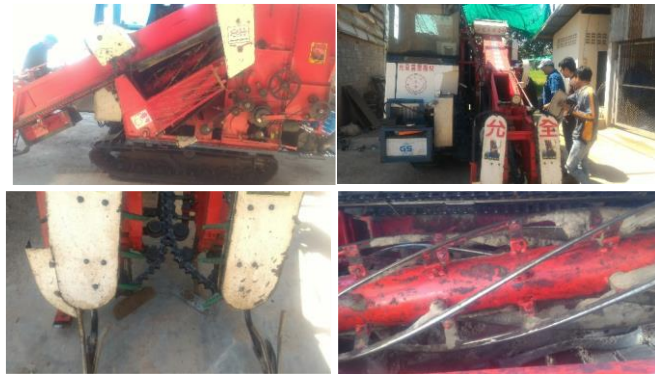
ภาพที่ 2.16 ใบชุด และโซ่หนีบต้นถั่ว และชุดปลิดฝัก ของเครื่องชุดถั่วลิสงจากไต้หวัน
