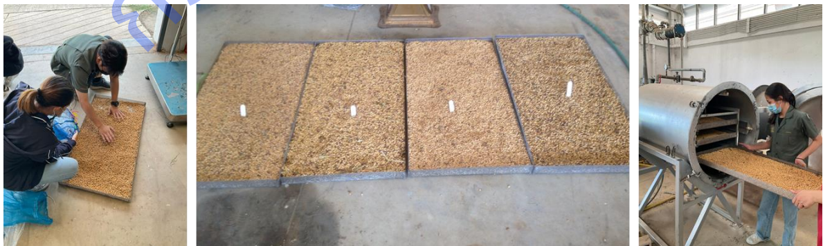
ภาพผนวกที่ 4.5 การเตรียมเมล็ดพันธุ์ถั่วเหลืองใส่ถาดตะแกรงและนำเข้าเครื่องอบลดแรงดันอากาศ
