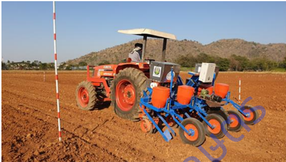
ภาพผนวกที่ 1.1 เครื่องหยอดเมล็ดพืชและปุ๋ยแบบอัตโนมัติที่ควบคุมอัตราการหยอดด้วยสมองกลฝังตัว
