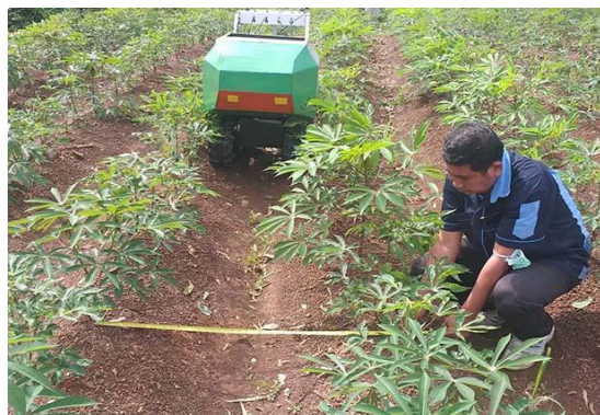
ภาพที่ 1 ซ้าย: แสดงภาพรวมของหุ่นยนต์ ขวา: ทดสอบการเคลื่อนที่ในร่องมัน
