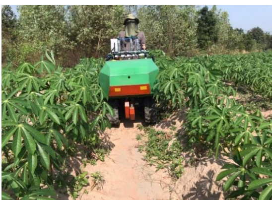
ภาพที่ 1 ซ้าย: แสดงภาพรวมของหุ่นยนต์ ขวา: ทดสอบการเคลื่อนที่ในร่องมัน
