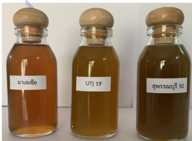
รูปที่ 2 น้ำอ้อยเข้มข้น 3 สายพันธุ์ ความหวาน 70-72 องศาบริกซ์
