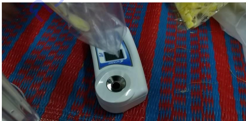
ภาพที่ 7 การวัดความหวานผลผลิตข้าวโพดหวาน
