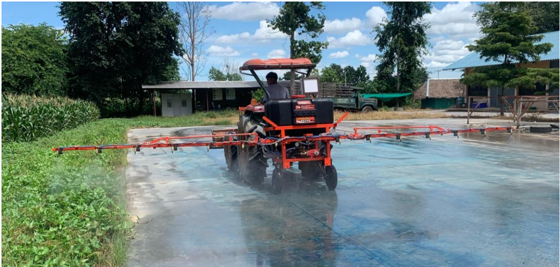
รูปที่ 17 การทดสอบเพื่อเปรียบเทียบอัตราการฉีดพ่น
