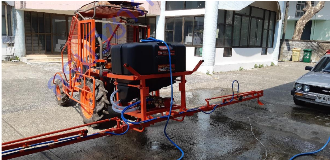
รูปที่ 2 เครื่องพ่นเนกประสงค์ ของ บ. สยามคูโบต้า จำกัด รุ่น BSM300
