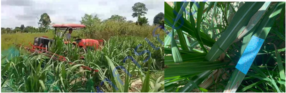
รูปที่ 19 การทดสอบวัดความหนาแน่นของละอองสารฯบนต้นอ้อย
