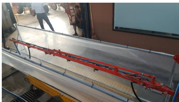
รูปที่ 14 ทดสอบการกระจายตัวของการฉีดพ่น
