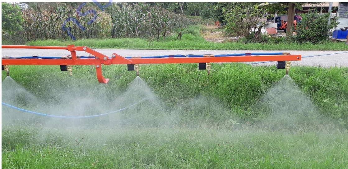
รูปที่ 10 หัวฉีดที่อยู่ติดกันจะไม่ปิดพร้อมกัน
