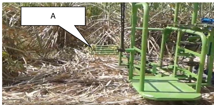
ภาพที่ 12 ตำแหน่งและลักษณะอุปกรณ์ปลิดใบอ้อย
