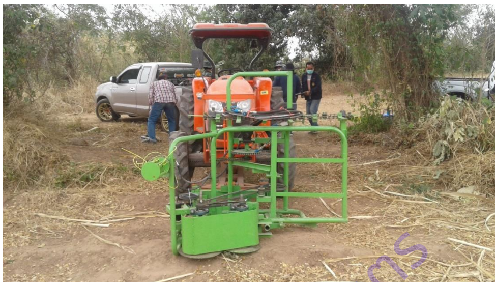
ภาพที่ 14 การเปลี่ยนตำแหน่งใบมีดและชุดป้องกันการม้วนเพลลา
