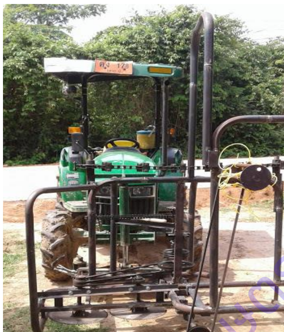
ภาพที่ 5 ตำแหน่งการจับยึด ทดแทนใบคันดินและตำแหน่งระบบไฮดรอลิก
