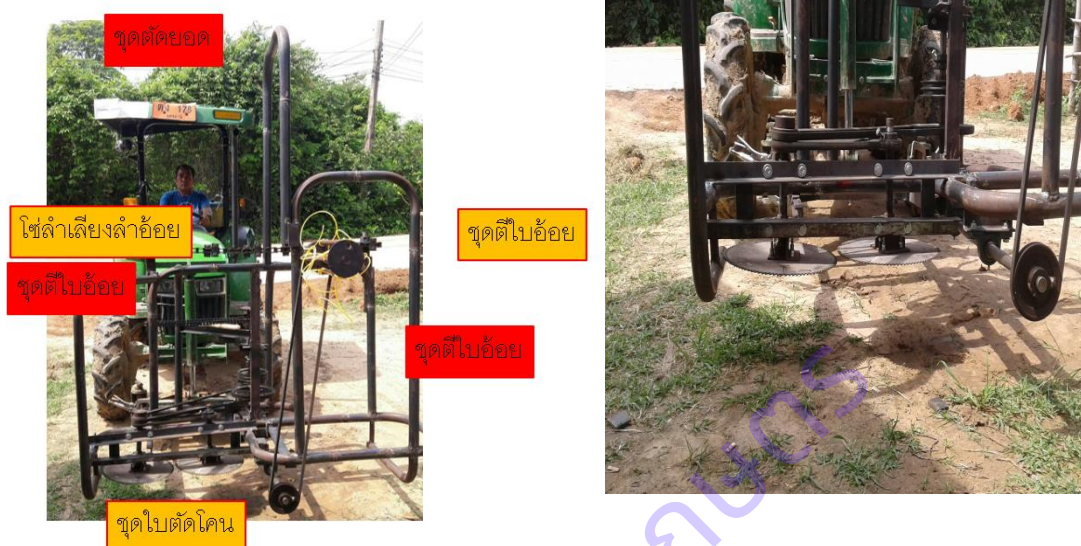
ภาพที่ 7 ตำแหน่งต่างๆ ของอุปกรณ์ภายในชุดต้นแบบเครื่องตัดฯ
