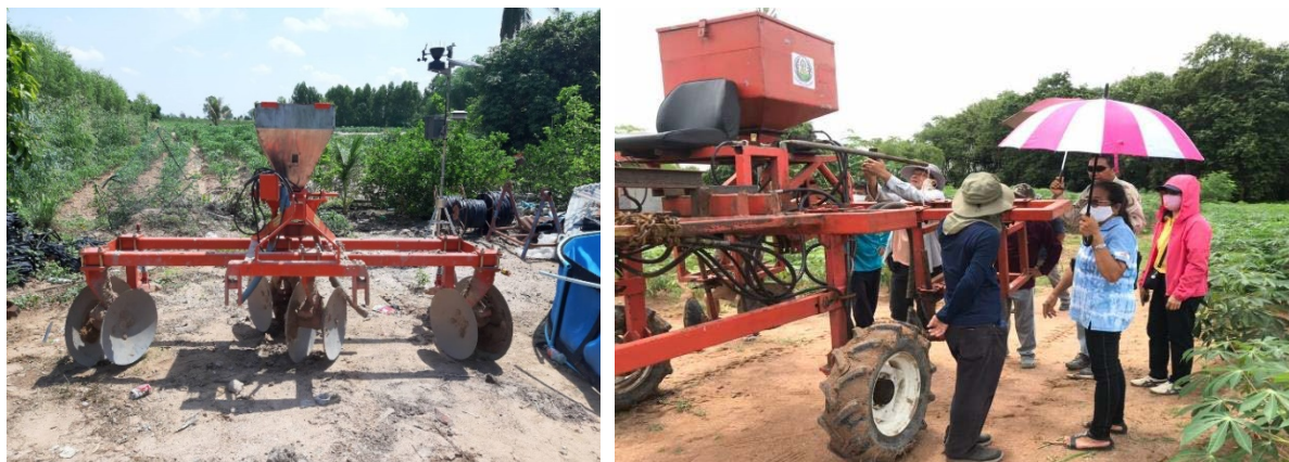
ภาพที่ 1 เครื่องใส่ปุ๋ยบนเครื่องยกร่องปลุกทดแทนการหว่านและเครื่องจักรแบบล้อยกสูงกำจัดวัชพืชและใส่ปุ๋ย
