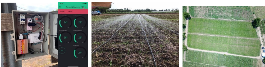
ภาพระบบการให้น้ำตามความต้องการของข้าวโพดโดยสั่งงานผ่านโทรศัพท์มือถือ
